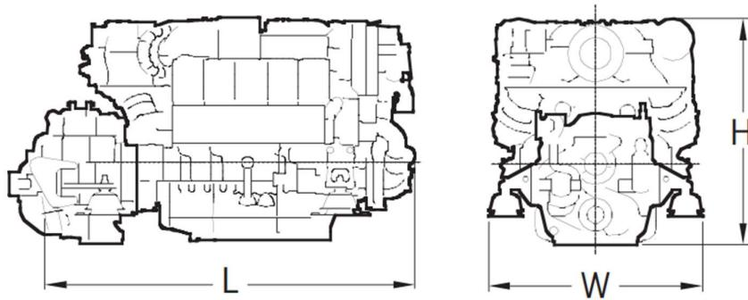
Slika 17. Dimenzije motora MTU 8V 2000 M72 [17]
