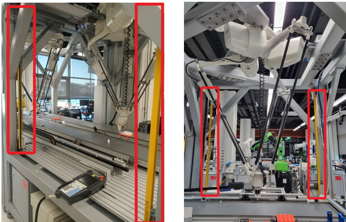
Slika 96. Prikaz montiranih sigurnosnih senzora – robotska ćelija delta-robotu M-3iA (lijevo) i robotska ćelija delta-robotu DR-3iB (desno)
