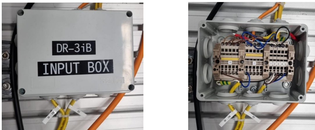
Slika 82. Prikaz vanjske input kutije za delta-robot DR-3iB
