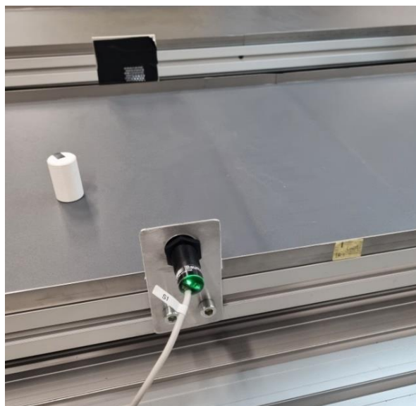
Slika 81. Prikaz instaliranog retroreflektivnog senzora
