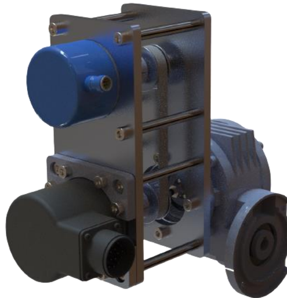
Slika 52. CAD model konstrukcije za montažu enkodera
