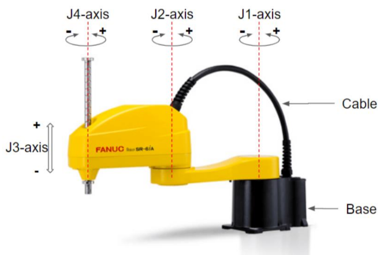
Slika 17. FANUC SCARA robot SR-6iA [10]
