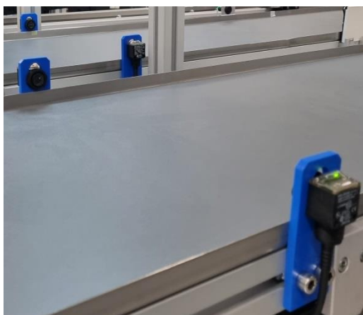
Slika 55. Prikaz instaliranog fotoelektričnog senzora
