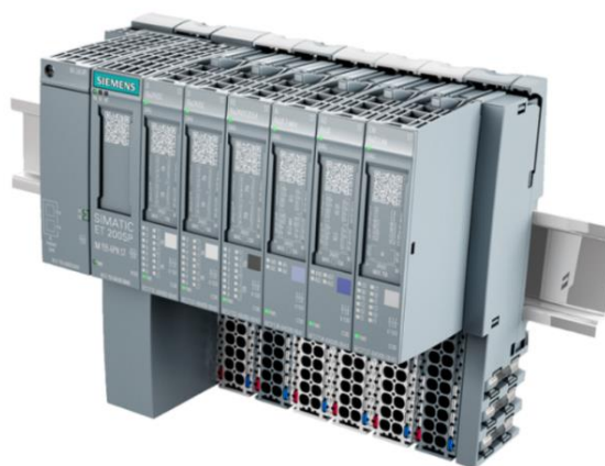
Slika 75. Distributivni I/O sustav ET200 SP [25]
