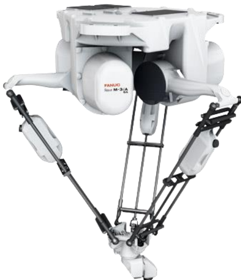
Slika 47. Fanuc delta-robot M-3iA [13]
