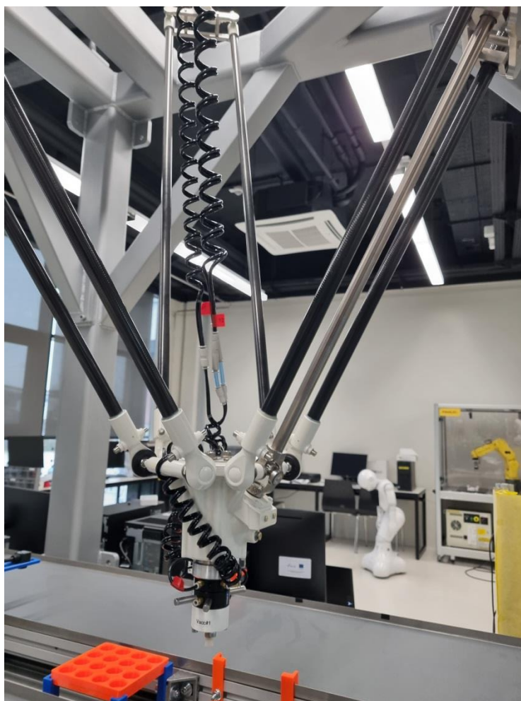
Slika 85. Prikaz spiralnih pneumatskih cijevi
