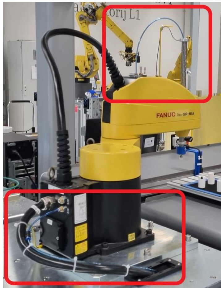
Slika 24. Prikaz spajanja pneumatike na Fanuc robota SR-6iA
