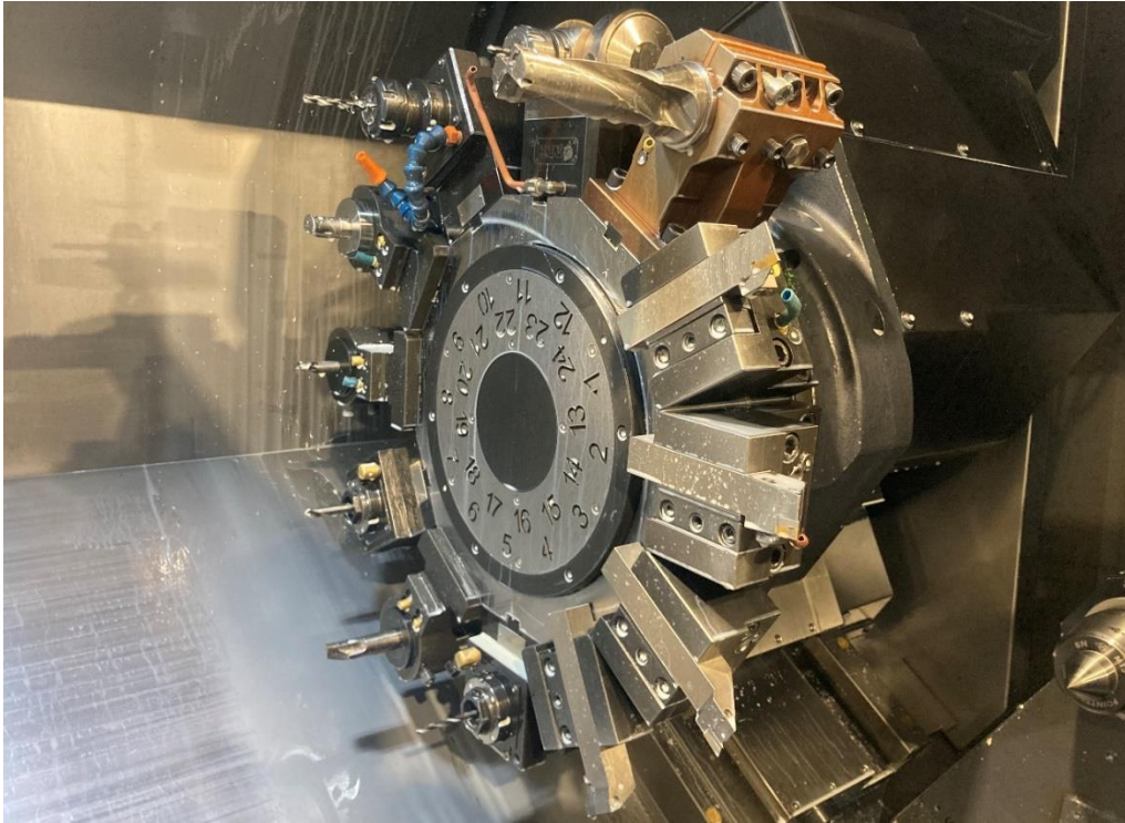
Slika 6. Zakretna revolverska glava za mirujuće i pogonjene alate - TOC
