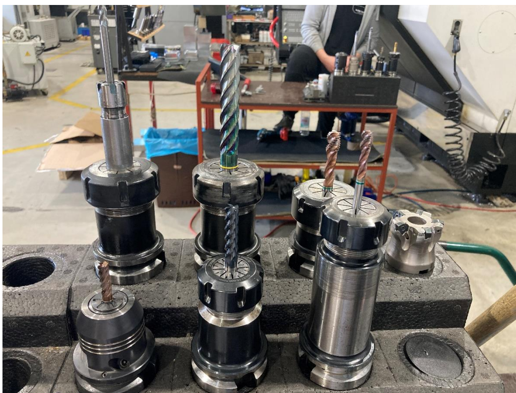
Slika 13. Primjer različitih glodala
