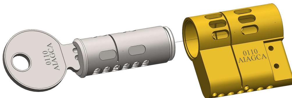
Slika 17.9 - Pravci ugradnje sklopa jezgre i uskočnika
