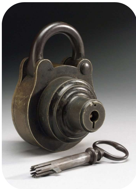
Slika 2.6 - Braham-ova cjevasta polužna brava na lokotu, ~1790.g [06]
