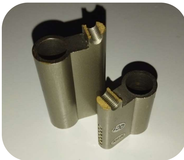
Slika 12.1 - Euro-cilindar nakon napada lomljenjem
