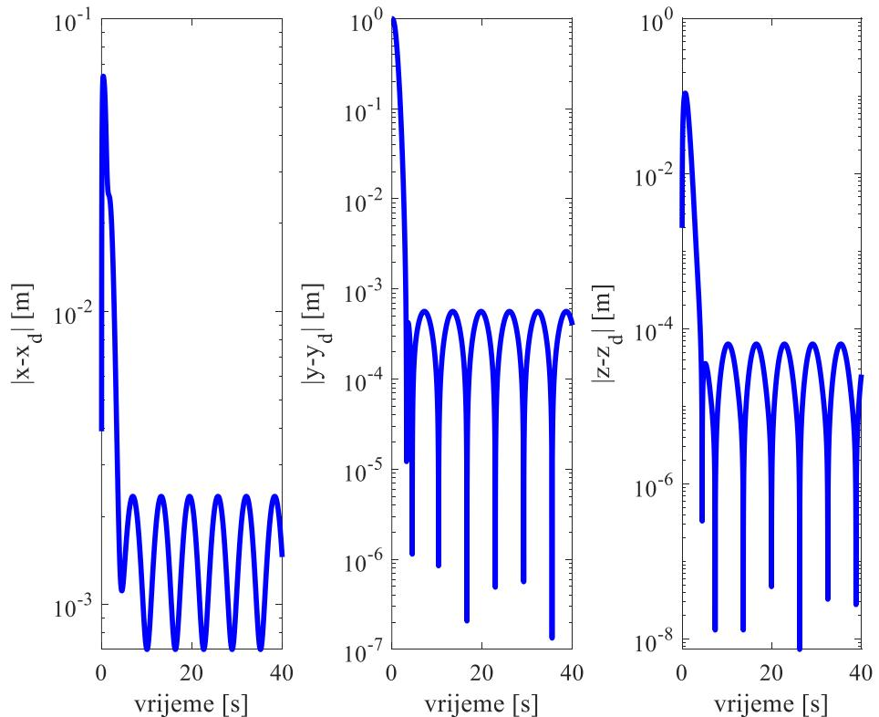
**Slika 5.28 Pogreške praćenja trajektorije za robusni regulator**
