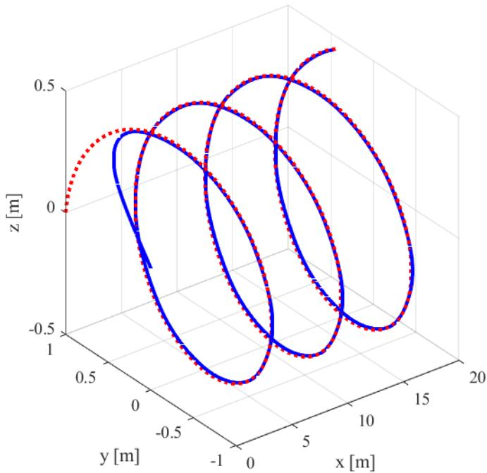
Slika 5.26 3D trajektorija vozila za robusni regulator
