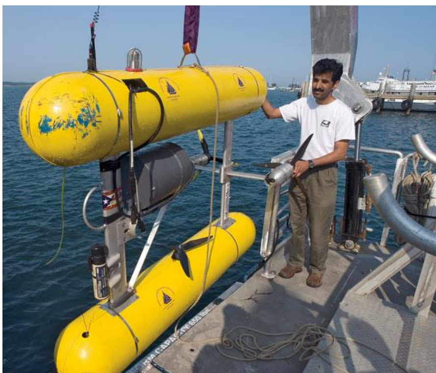
Slika 2.3 Autonomno podvodno vozilo SeaBED [4]
