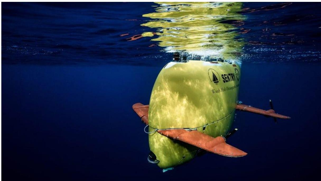
Slika 2.4 Autonomno podvodno vozilo SENTRY [5]
