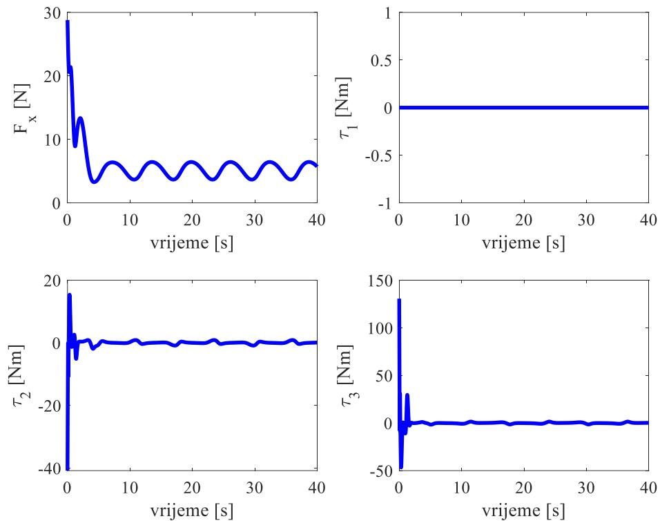
**Slika 5.17 Upravljačke varijable vozila za linearni regulator**
