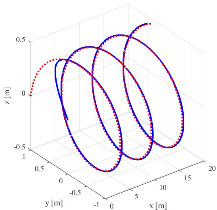
**Slika 5.20 3D trajektorija vozila za adaptivni regulator**
