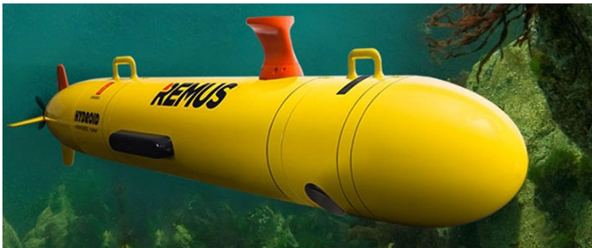
Slika 2.2 Autonomno podvodno vozilo REMUS [3]
