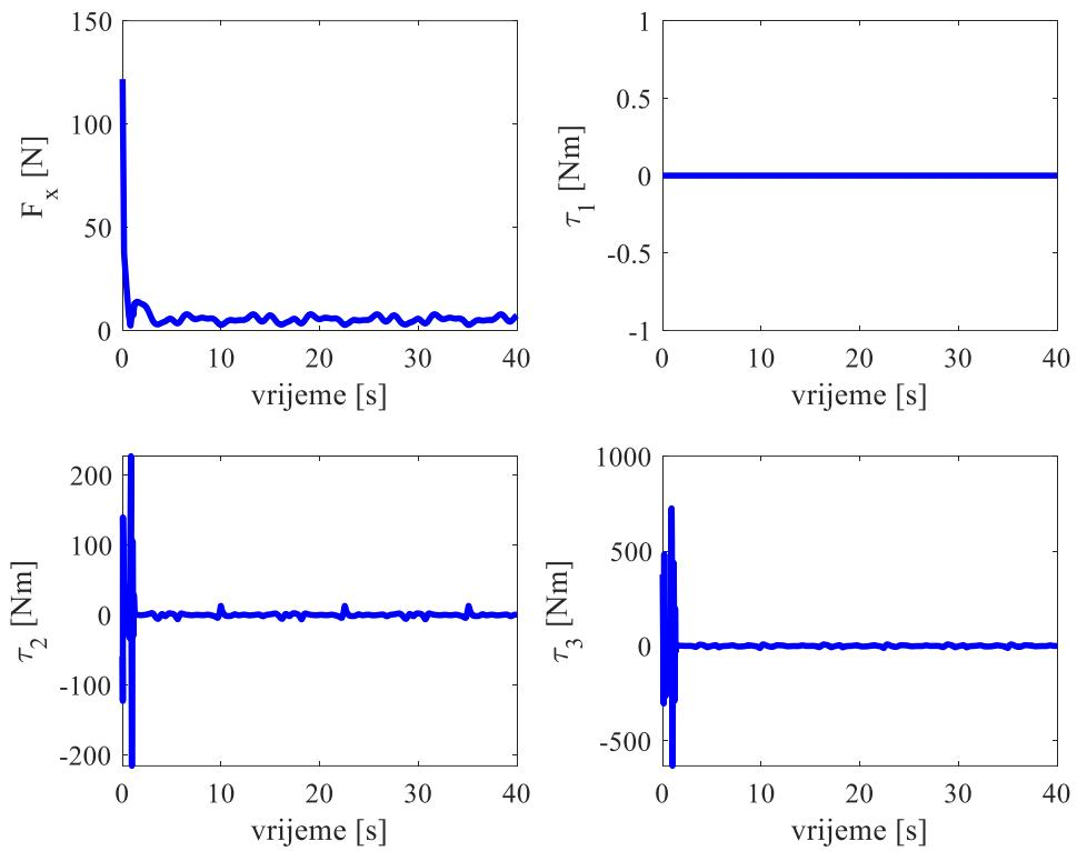
**Slika 5.27 Upravljačke varijable vozila za robusni regulator**
