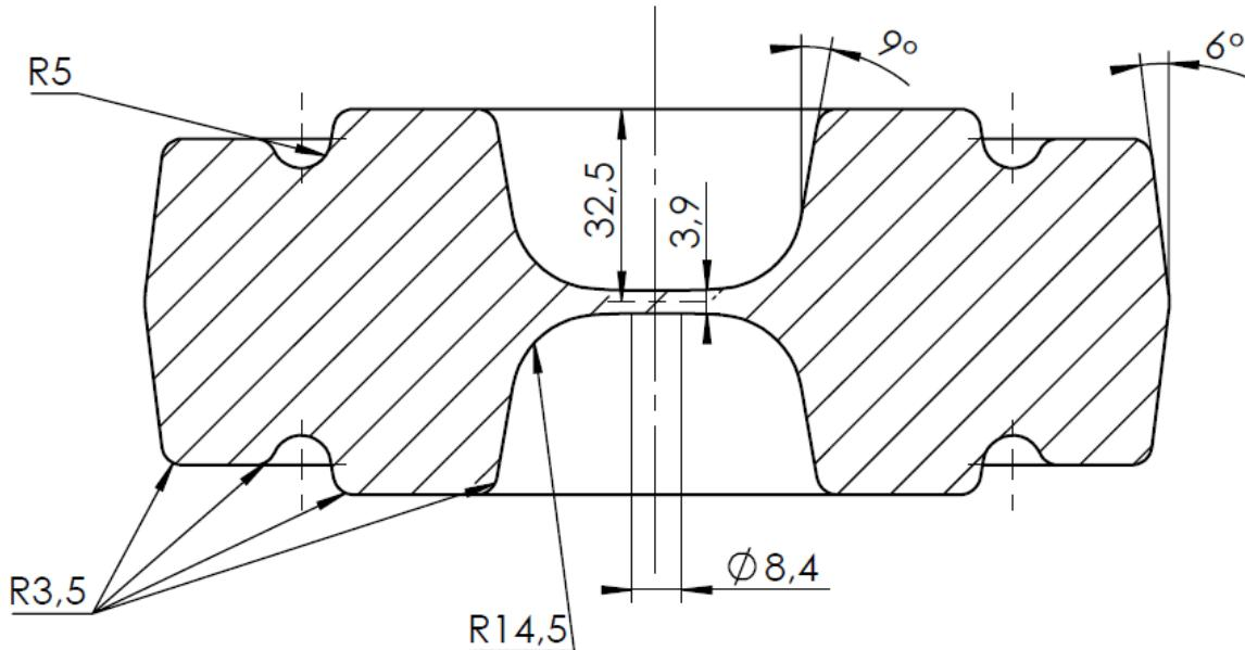
**Slika 41.** Otkovak s radiusima zaobljenja, pločicom za probijanje i kovačkim nagibima
