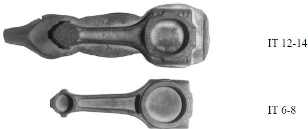
Slika 9. Klipnjača izrađena kovanjem u otvorenom i zatvorenom ukovnju [1]
