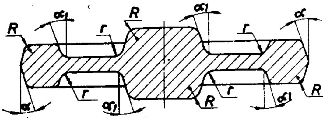
Slika 39. Vanjski i unutarnji radius zaobljenja i vanjski i unutarnji nagibi [3]
