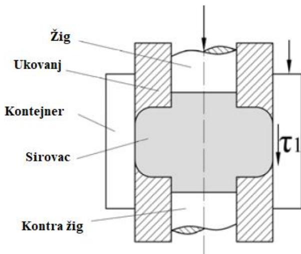
Slika 12. Precizno kovanje s vanjskim okvirom alata [1]
