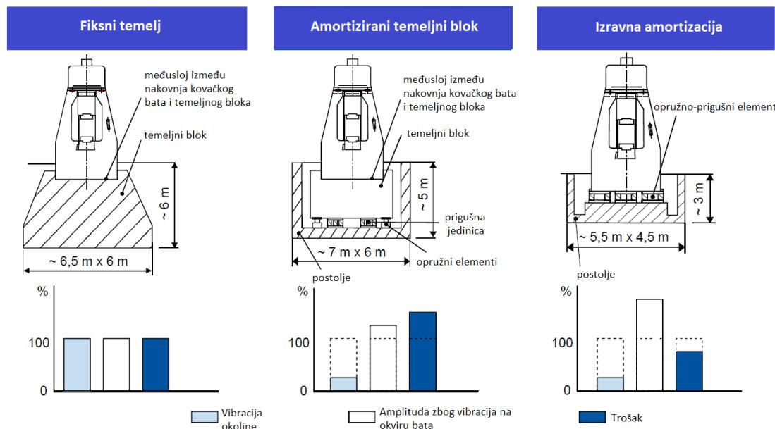
Slika 18. Izoliranje vibracija na strojevima za oblikovanje deformiranjem [11]
