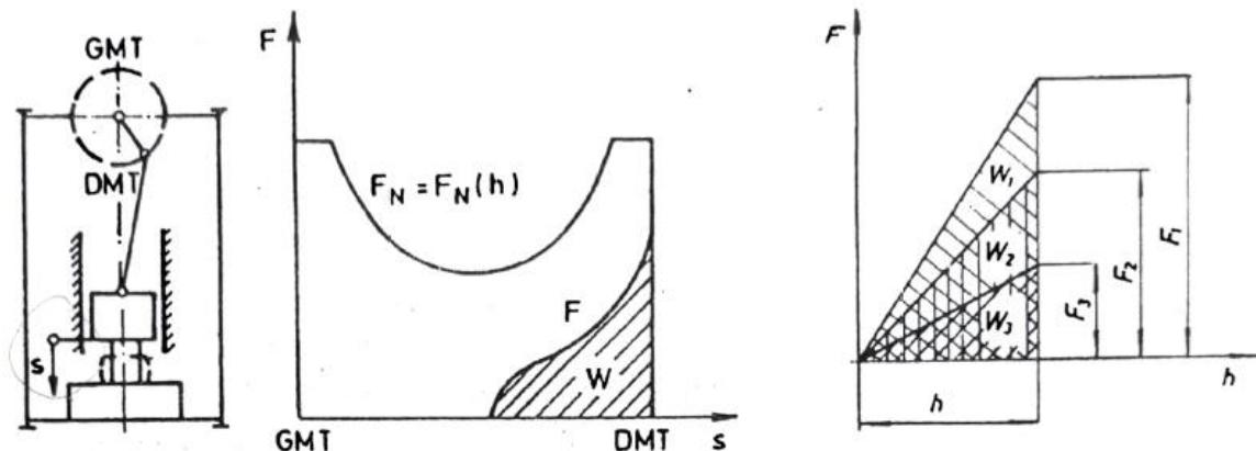
**Slika 15. Strojevi sa zagarantiranim hodom alata [2]**
