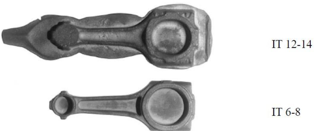
**Slika 9. Klipnjača izradena kovanjem u otvorenom i zatvorenom ukovnju [1]**
