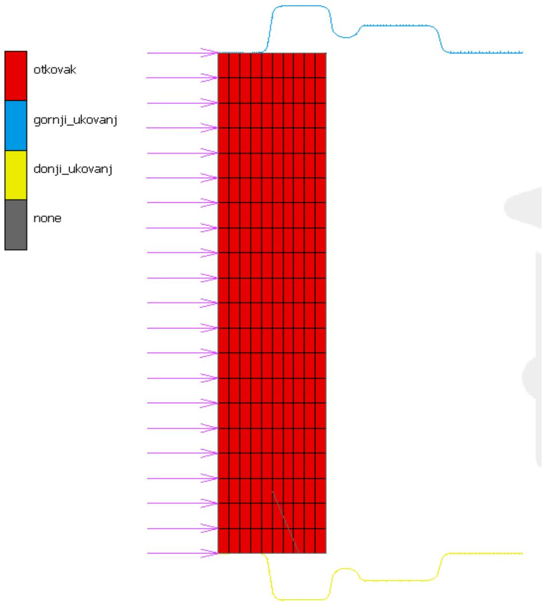
**Slika 56.** Osnosimetrična geometrija za simulaciju
