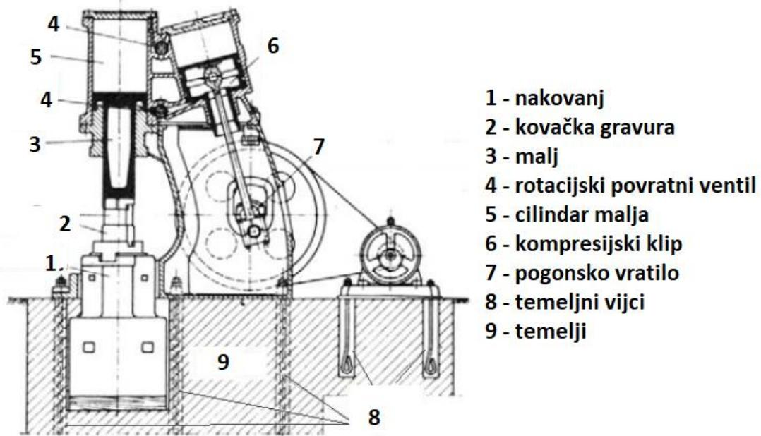
**Slika 22. Dvoradni pneumatski bat za slobodno kovanje [12]**
