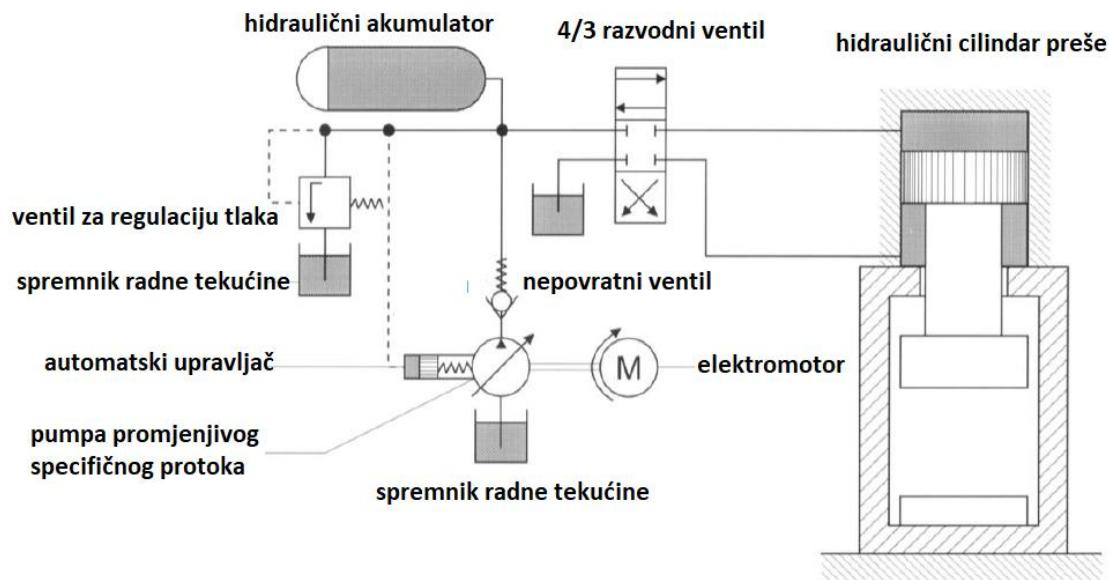
Slika 28. Hidraulična shema za preš [11]
