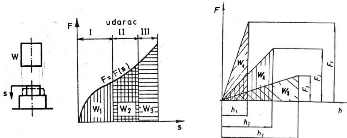
**Slika 14. Strojevi sa zagarantiranim radom (energijom deformacije) [2]**
