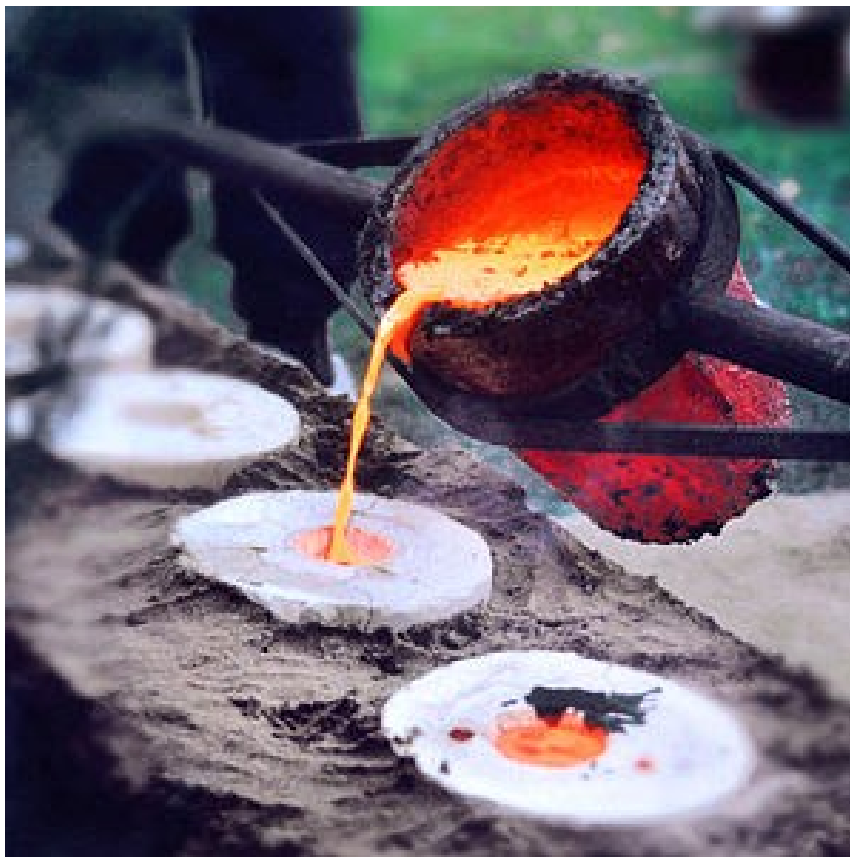
Slika 21. Lijevanje u kalupe [17]
