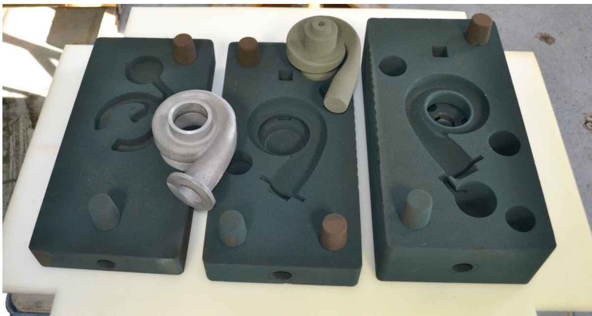
Slika 29. Odljevak dobiven s pomoću 3D ispisanog kalupa i jezgre [21]
