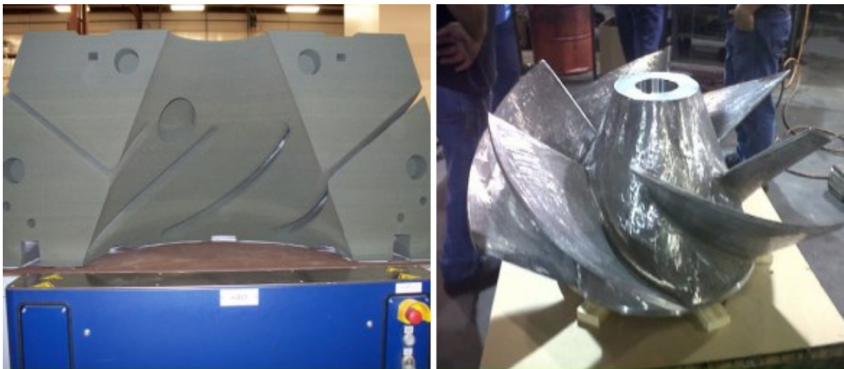
Slika 30. Jezgra dobivena aditivnom proizvodnjom (lijevo); gotovi odljevak (desno) [22]
