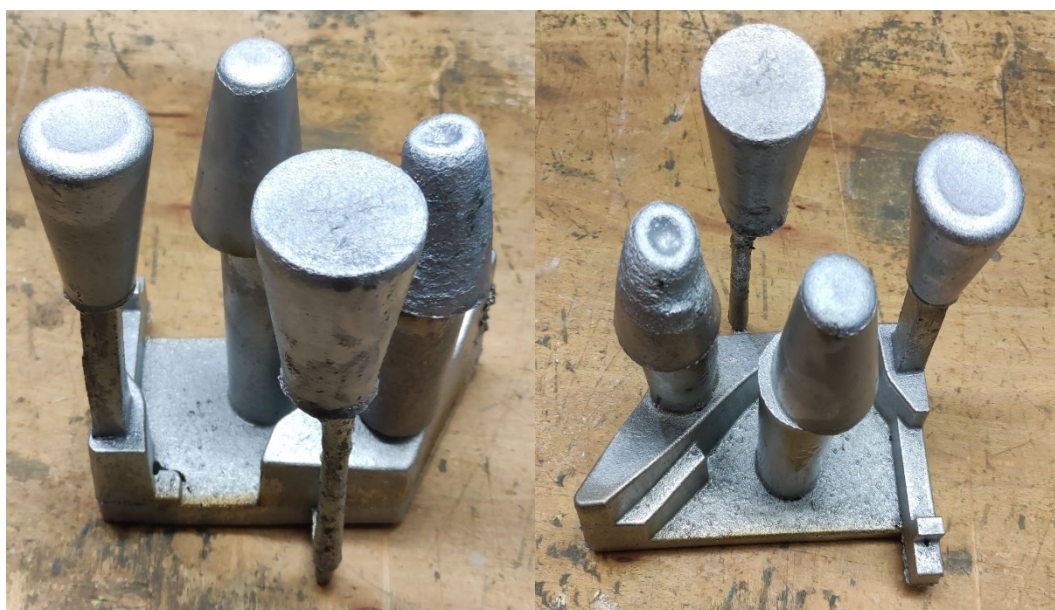
Slika 63. Naprava nakon vadenja iz kalupa
