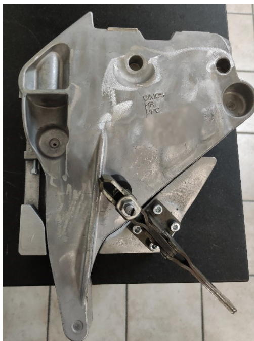
Slika 69. Provjera nalijeganja nosača motora na napravu
