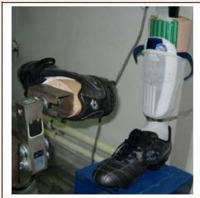
Slika 9. Eksperiment prodora tijekom udara s kopačkom [12]
