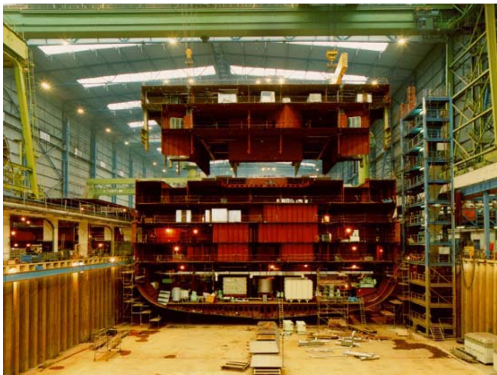
Slika 8 Montaža blokova trupa u natkrivenoj hali brodogradilišta Meyer Werft u Papenburg [17]
