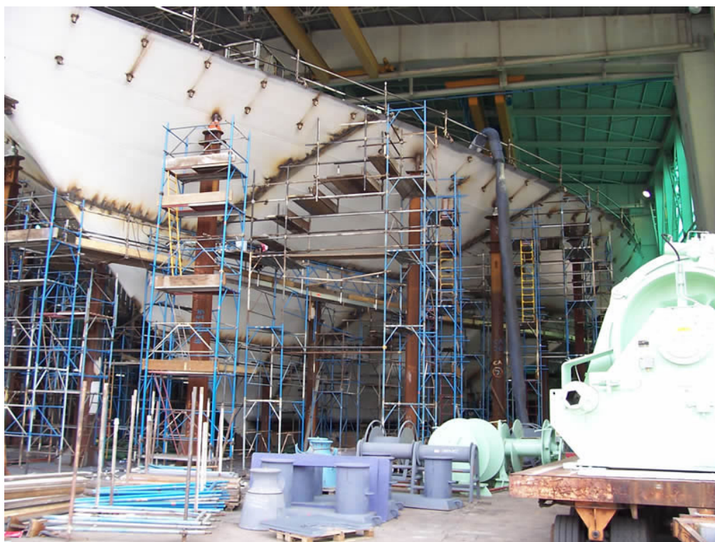
Slika 31 Opremanje sekcije pramca broda za kružna putovanja u brodogradilištu "Fincantieri Monfalcone"
