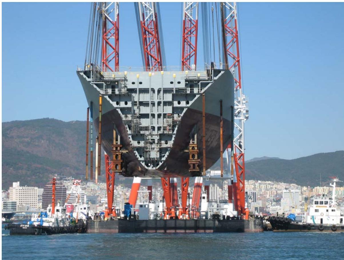
Slika 5 Plovna dizalica brodogradilišta Samsung podiže megablok
