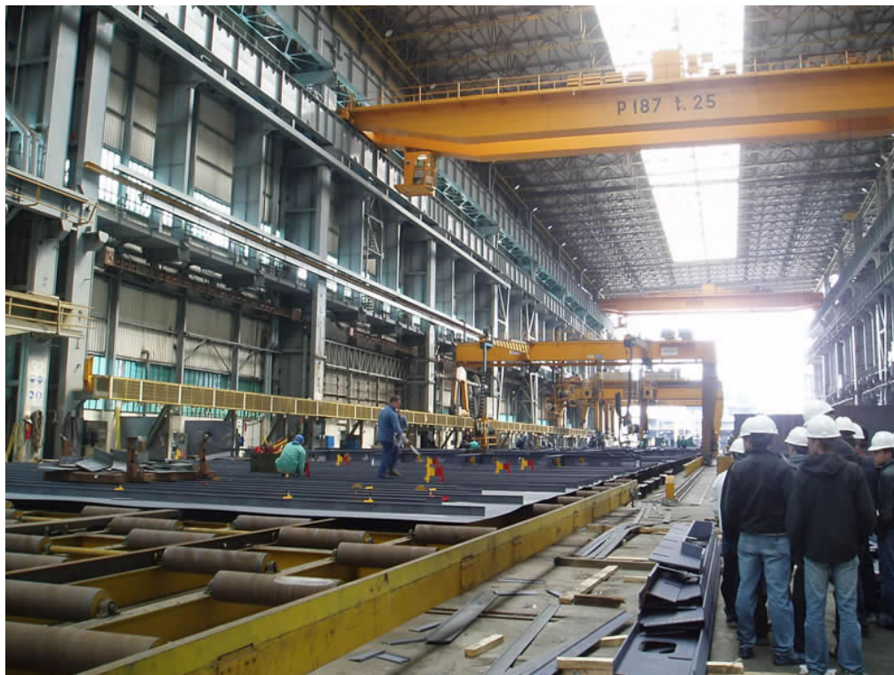
Slika 30 Panel linija u brodograđevnoj radionici brodogradilišta "Fincantieri Monfalcone" 21
