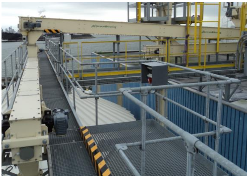
Slika 19. Konvejeri tipa JHK25 u radu [15]
