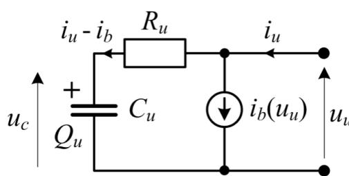
Slika 4: Pojednostavljeni Strujni krug ultrakondenzatora
