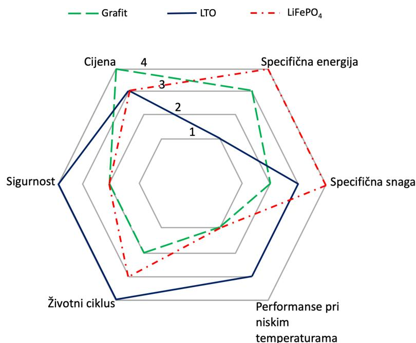
Slika 1: Karakteristike baterije (1: Loše karakteristike, 2: Odlične karakteristike)
