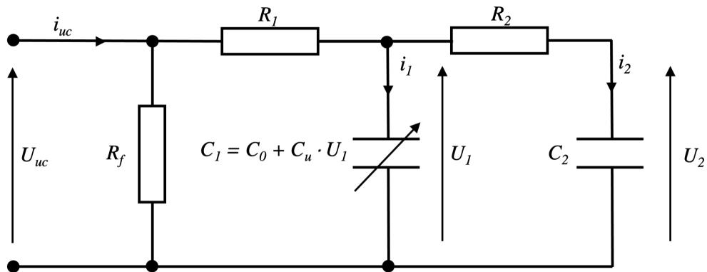
Slika 3: Strujni krug ultrakondenzatora
