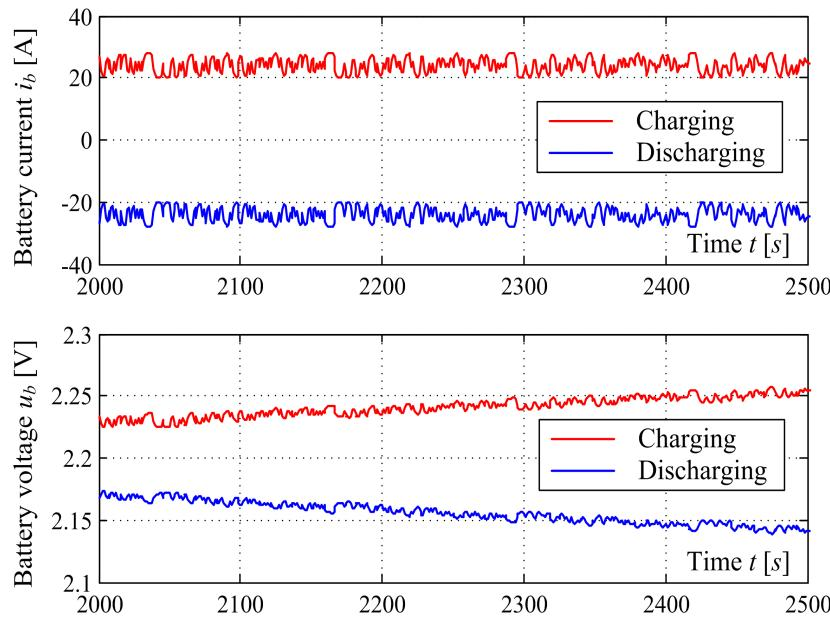
Slika 15: Usporedni eksperimentalni tragovi tijekom punjenja i pražnjenja s prosječnom (DC) strujom od 24 A sa superponiranim perturbacijama PRBS signalima od  $\pm 4$  A.
