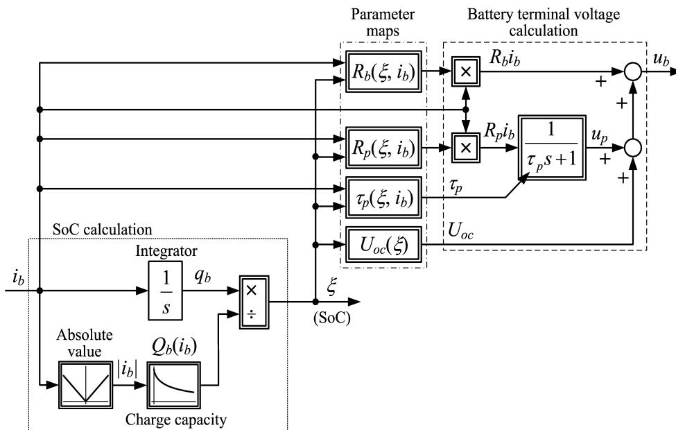
Slika 25: Blok dijagram ekvivalentnog strujnog kruga baterije
