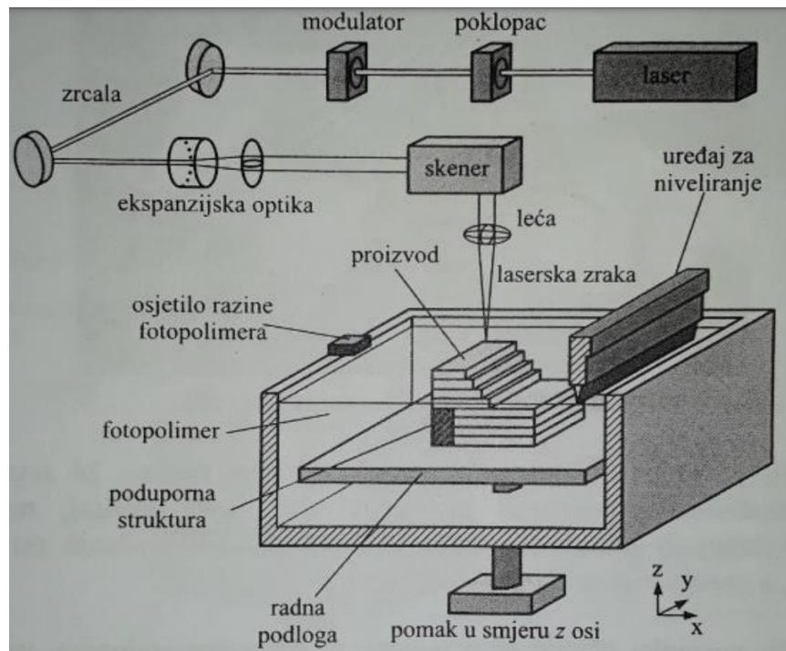
Slika 2: Stereolitografski postupak [2]
