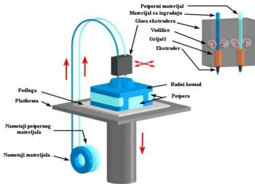
Slika 3: Princip rada uređaja prilikom FDM postupka [2]
