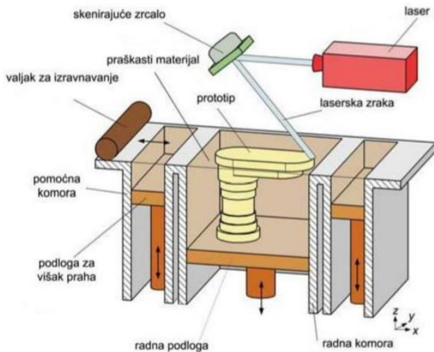
Slika 4: Princip rada uređaja prilikom SLS postupka [2]
