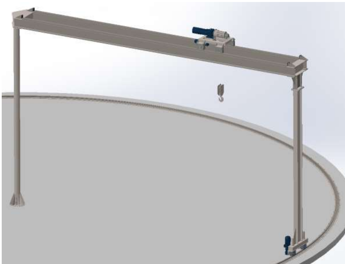
Slika 5.1. 3D model rotacijskog portalnog granika
