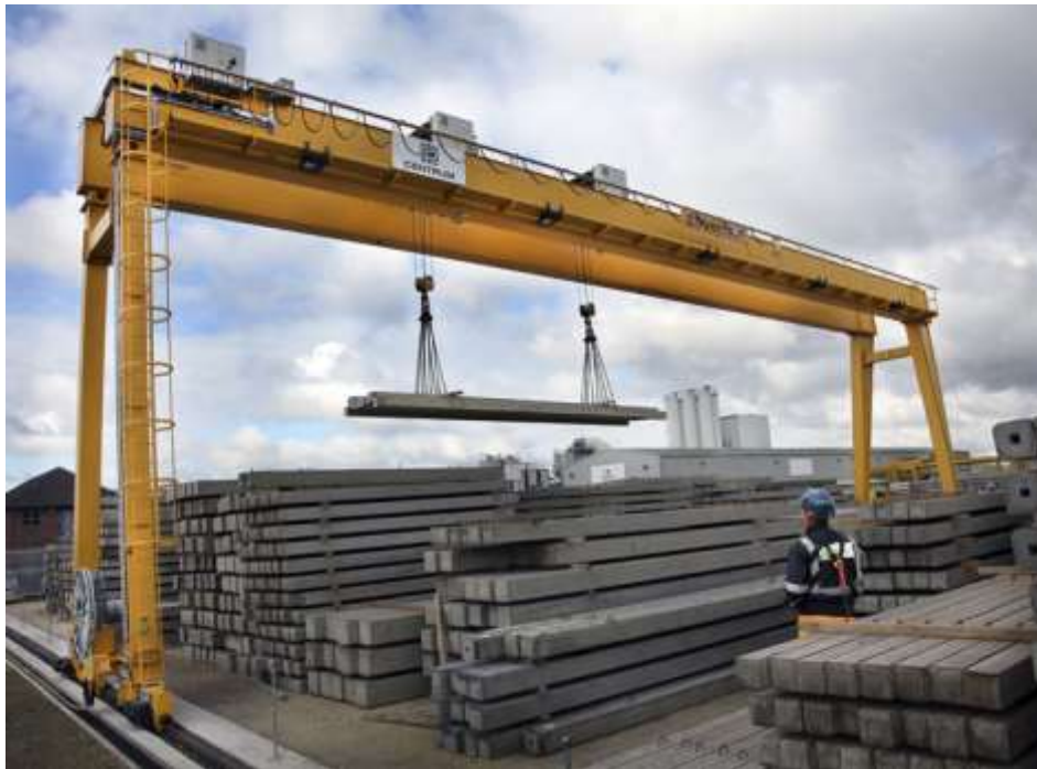
Slika 1.1. Primjer portalnog granika [6]
