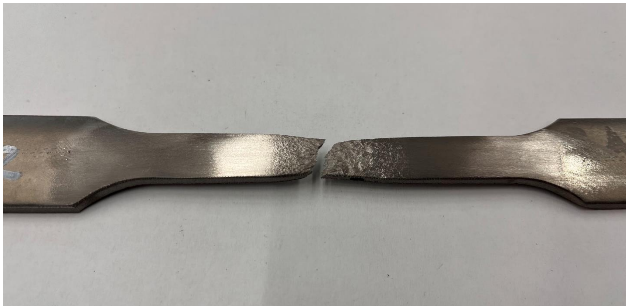
Slika 28. Slomljeni ispitni uzorak nakon statičkog vlačnog ispitivanja
