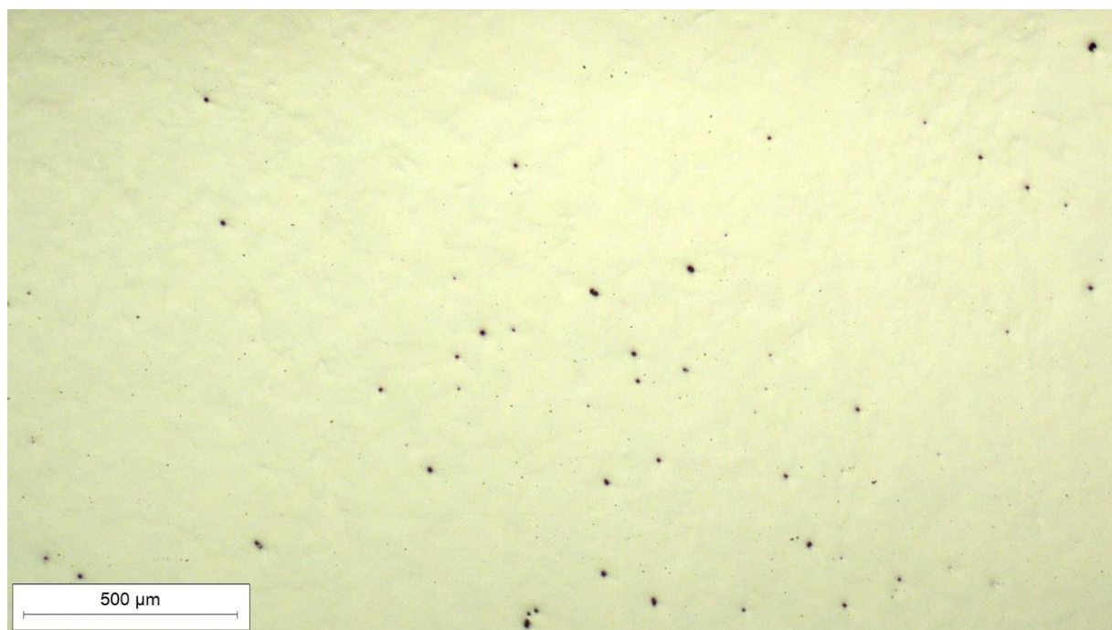
Slika 34. Mikrostruktura osnovnog materijala u poliranom stanju, snimljeno pri povećanju 50×
