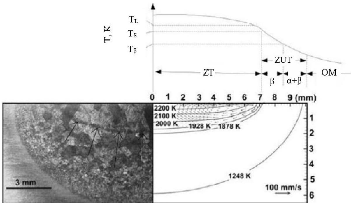
Slika 12. Temperaturna područja zavarenog spoja TiAl6V4 legure [30]
