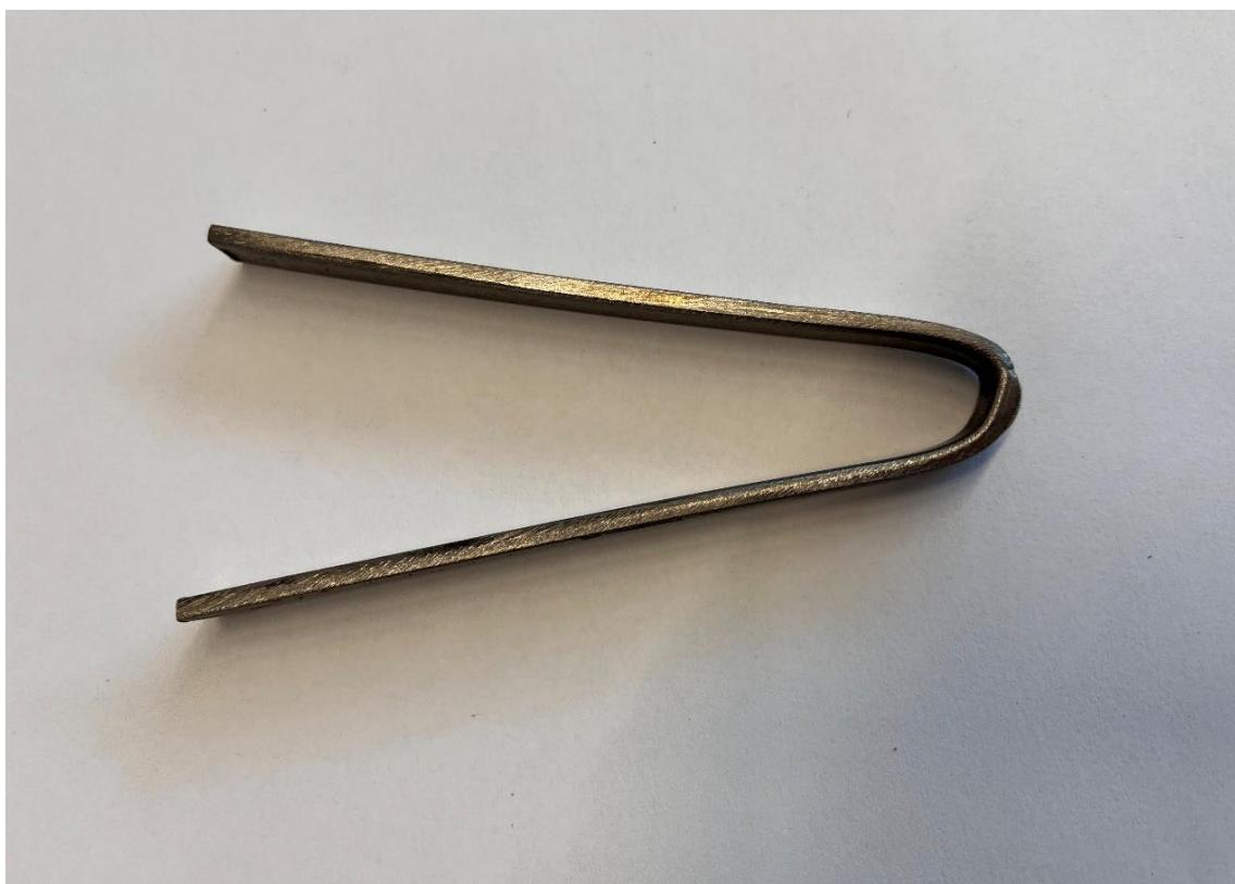
Slika 24. Ispitni uzorak nakon završenog savojnog ispitivanja
