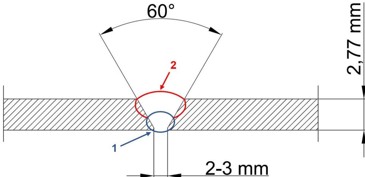
**Slika 20.** Shematski prikaz zavarivanja cijevi s redoslijedom prolaza
