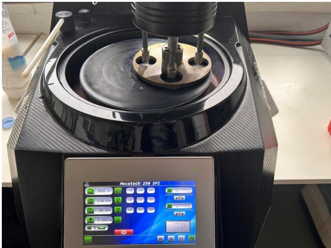
Slika 32. Postupak brušenja uzorka na uređaju Mecatech 250 SPI
