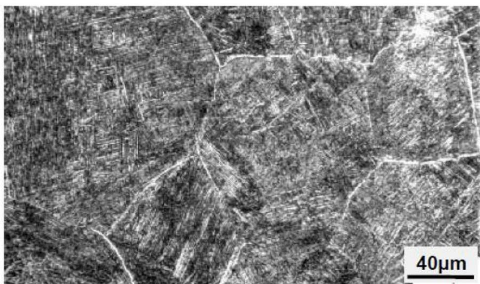
Slika 14. Mikrostruktura ZUT-a zavarenog spoja titanijeve legure [27]
