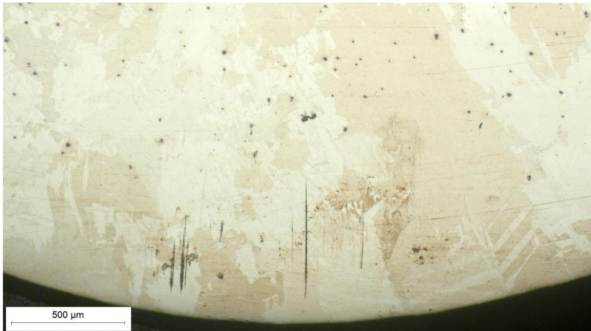
Slika 45. Mikrostruktura metala zavara u korijenu, snimljeno pri povećanju 50×
