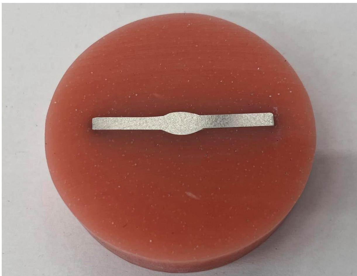
Slika 29. Makrostruktura zavarenog spoja prije procesa nagrizanja
