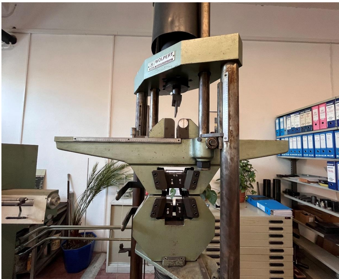
Slika 21. Kidalica prilagođena za savojno ispitivanje
