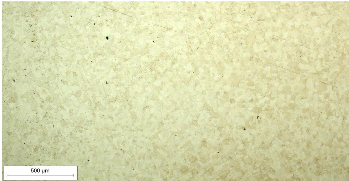
**Slika 37.** Mikrostruktura osnovnog materijala u nagrizenom stanju, snimljeno pri povećanju  $50\times$
