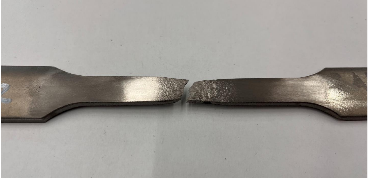
Slika 28. Slomljeni ispitni uzorak nakon statičkog vlačnog ispitivanja
