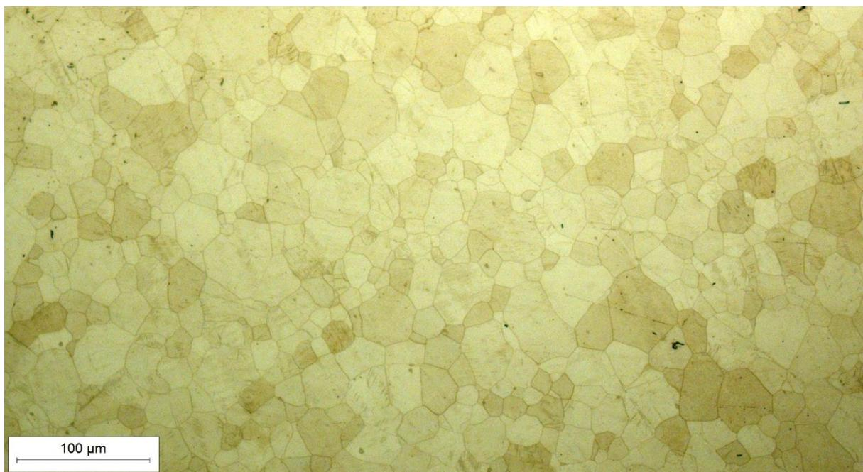
**Slika 38.** Mikrostruktura osnovnog materijala u nagrizenom stanju, snimljeno pri povećanju  $200\times$
