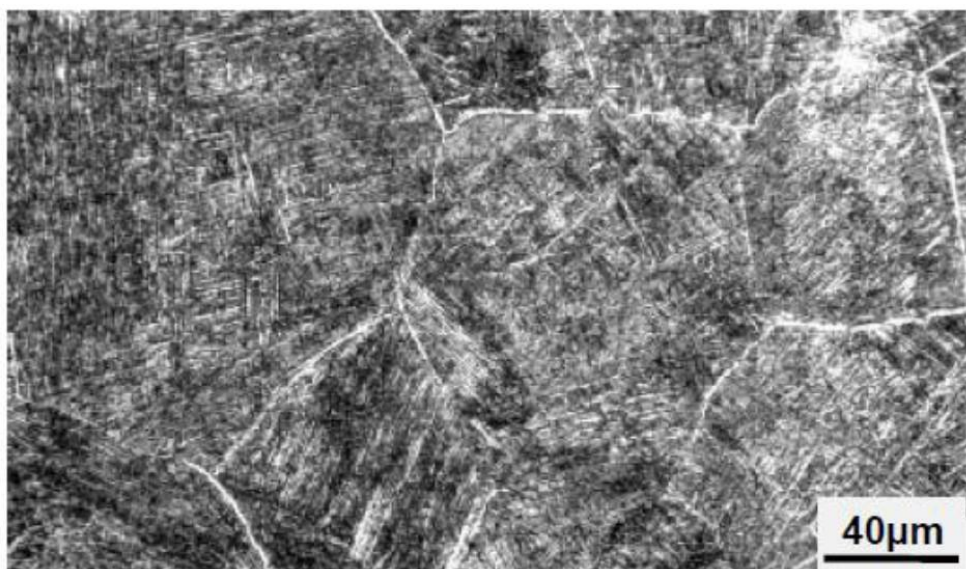
Slika 14. Mikrostruktura ZUT-a zavarenog spoja titanijeve legure [27]
