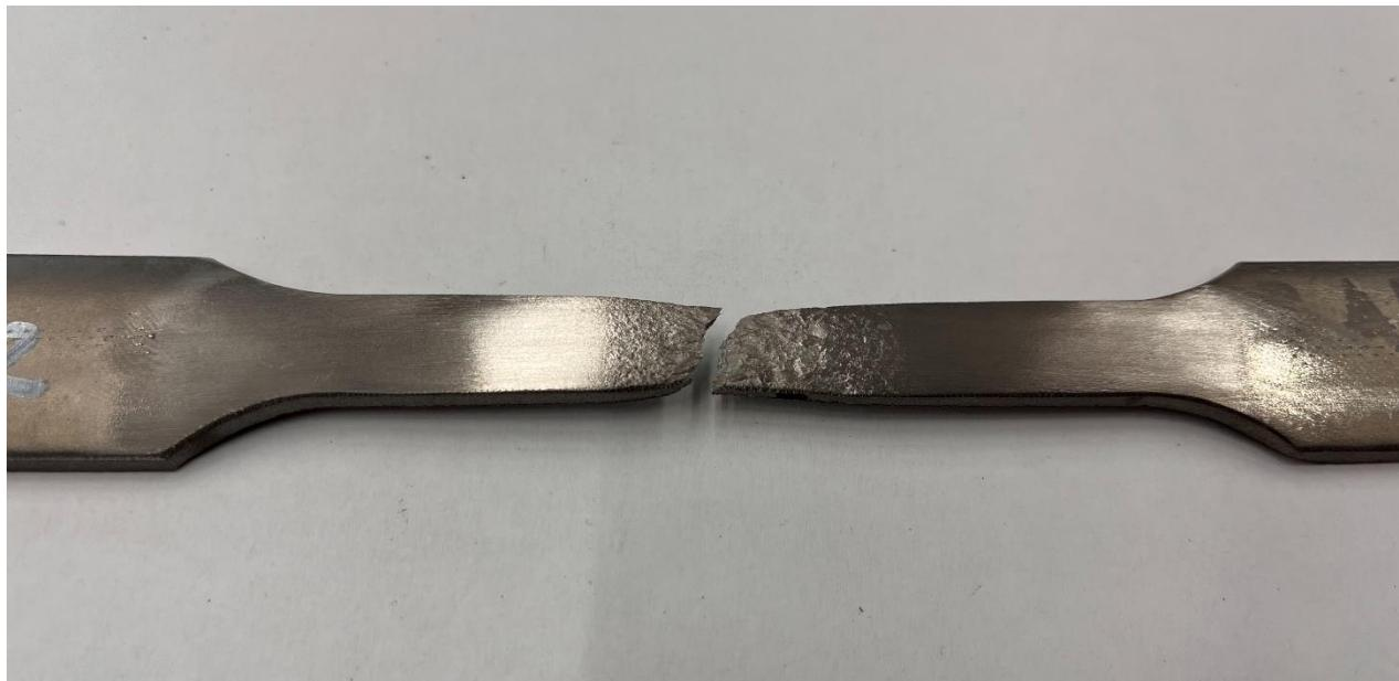
**Slika 28.** Slomljeni ispitni uzorak nakon statičkog vlačnog ispitivanja
