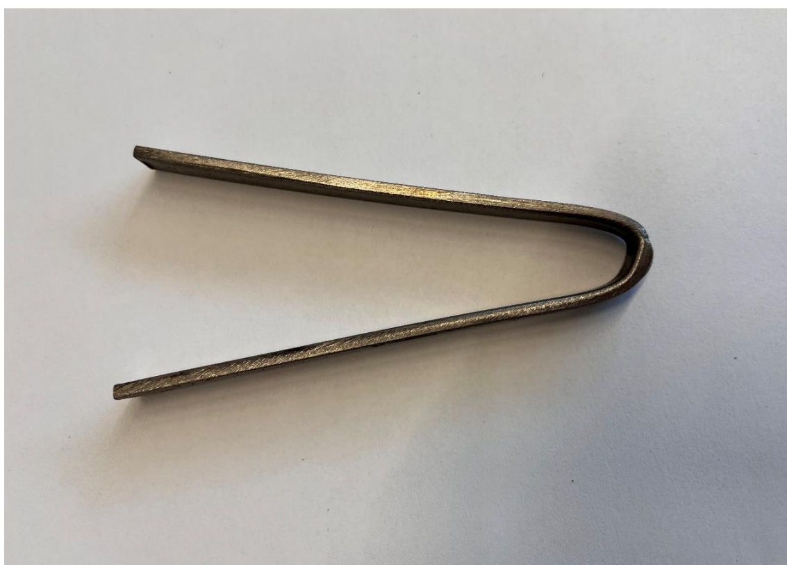
Slika 24. Ispitni uzorak nakon završenog savojnog ispitivanja
