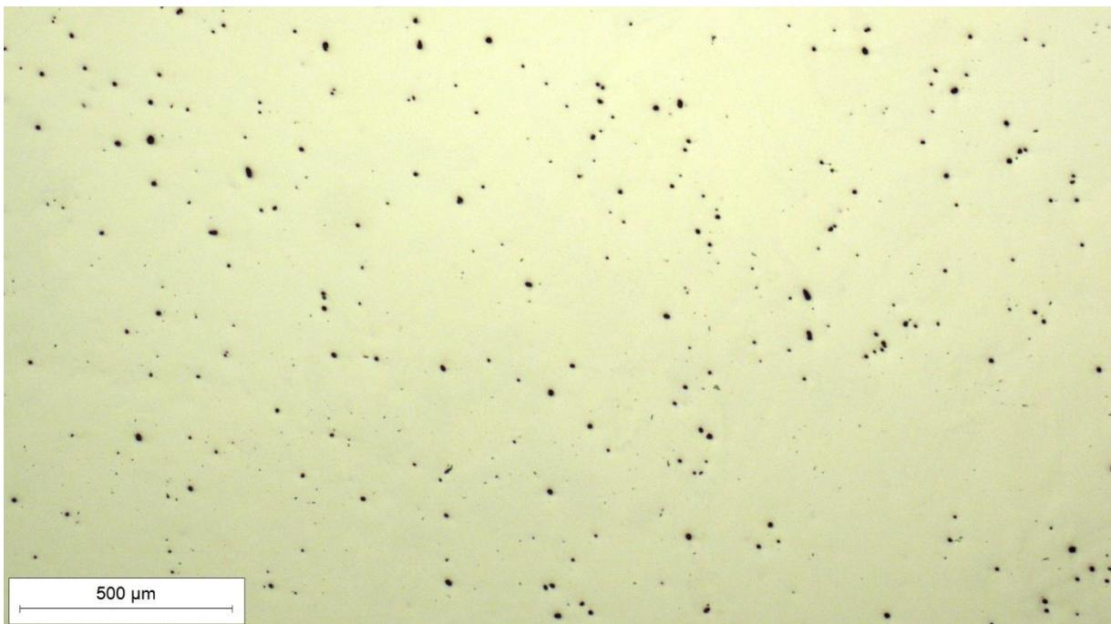
Slika 35. Mikrostruktura metala zavara u poliranom stanju, snimljeno pri povećanju 50×
