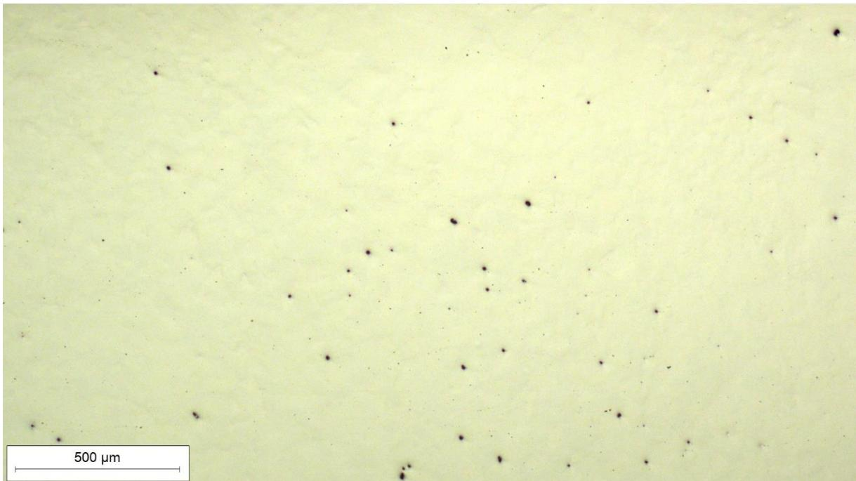
Slika 34. Mikrostruktura osnovnog materijala u poliranom stanju, snimljeno pri povećanju 50×
