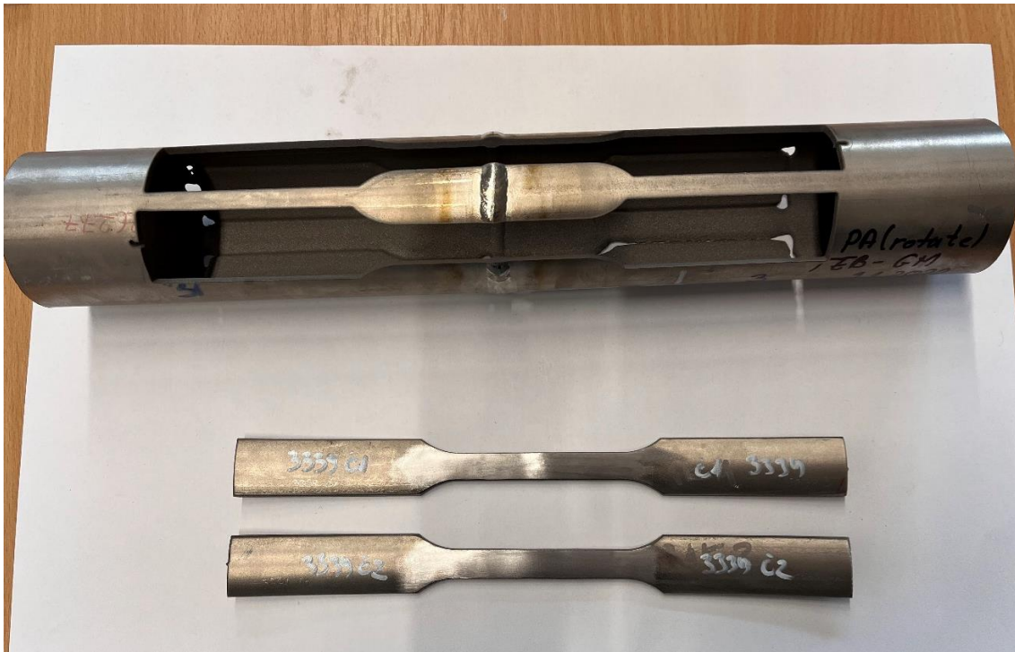
Slika 26. Ispitni uzorci za ispitivanje vlačne čvrstoće
