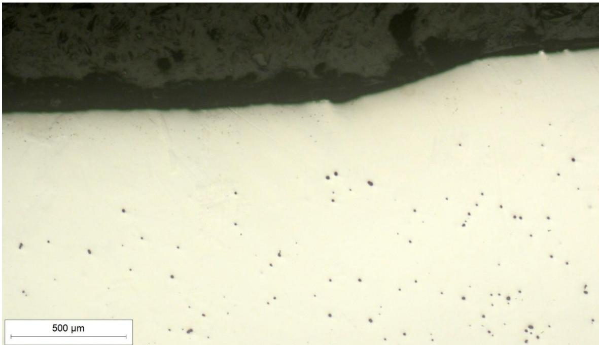
**Slika 36.** Mikrostruktura zone utjecaja topline u tjemenu zavara u poliranom stanju, snimljeno pri povećanju  $50\times$
