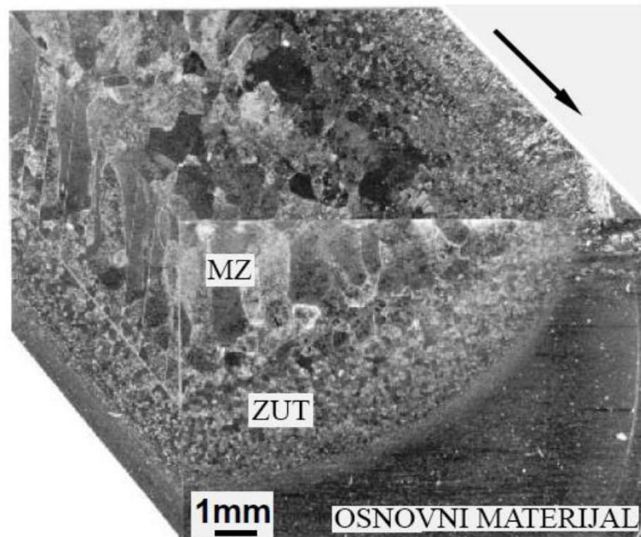
Slika 13. Mikrostruktura TIG zavarenog spoja titanijeve legure [27]
