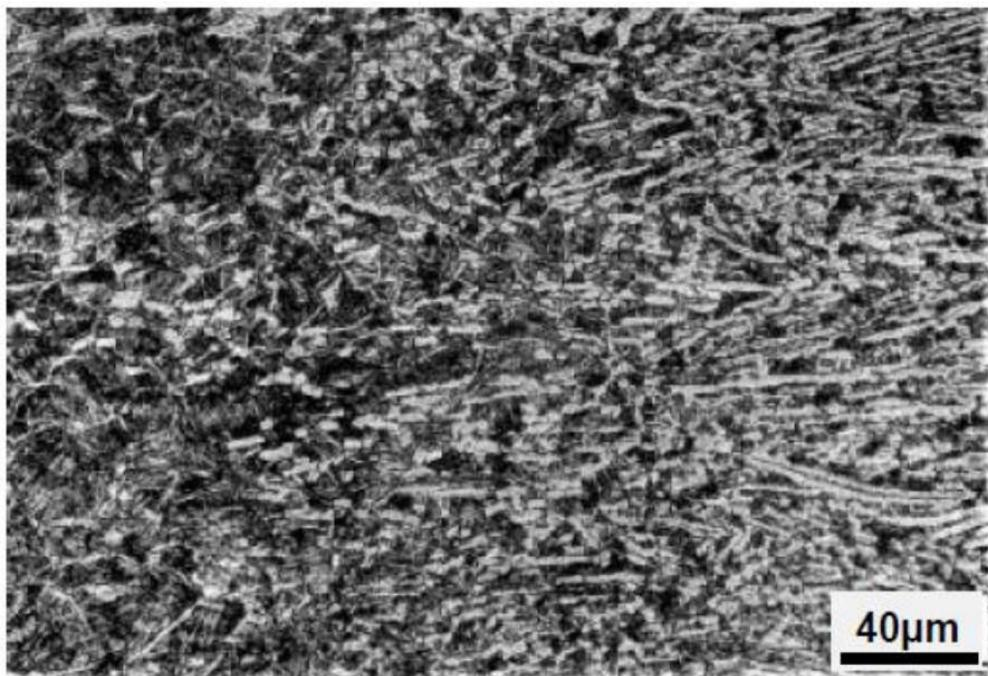
**Slika 15. Mikrostruktura dijela ZUT-a koji nije zagrijan iznad temperature  $\alpha/\beta$  prekristalizacije [27]**
