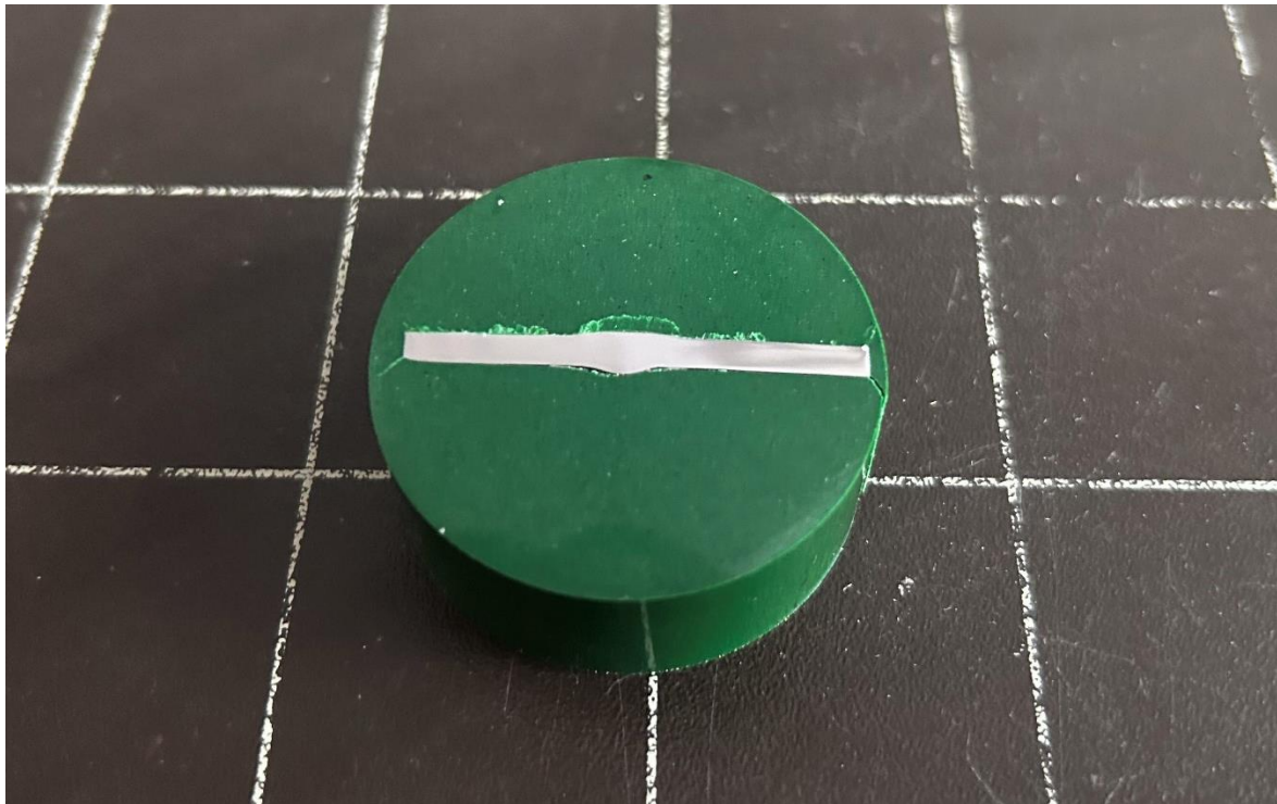
Slika 33. Uzorak zavarenog spoja u poliranom stanju
