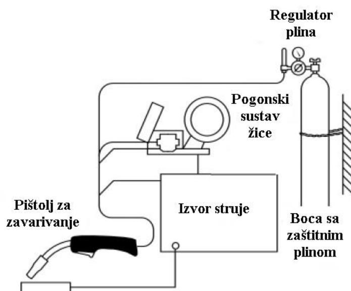
Slika 10. Prikaz opreme za zavarivanje MIG metodom [24]
