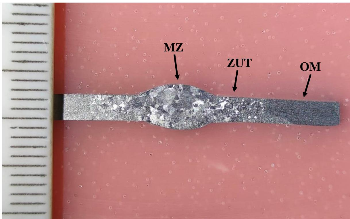
Slika 30. Makrostruktura zavarenog spoja u nagrizenom stanju
