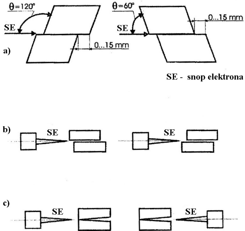
Slika 9. Tehnološka odstupanja pri montaži zavarenog spoja: a) smicanje, b) razmicanje, c) otvaranje rubova [22]
