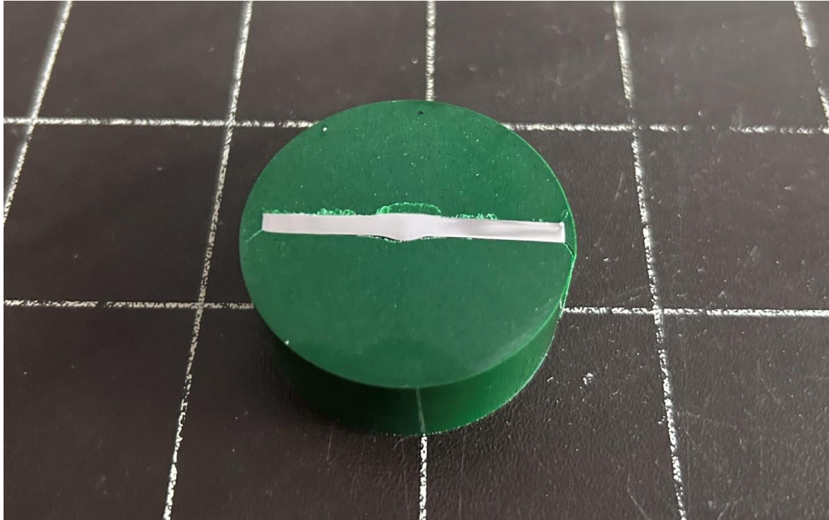
Slika 33. Uzorak zavarenog spoja u poliranom stanju
