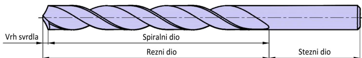
Slika 1.3. Dijelovi spiralnog svrdla [3]
