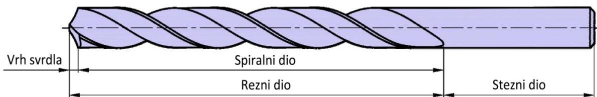
Slika 1.3. Dijelovi spiralnog svrdla [3]
