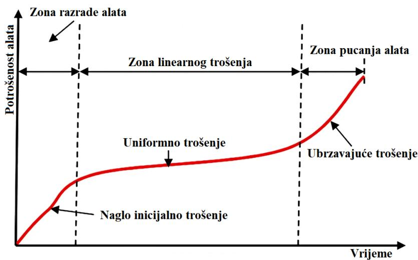
**Slika 2.3.** Trošenje alata tijekom njegova radnog vijeka [8]
