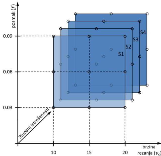
**Slika 3.10.** Vizualni prikaz kombinacija parametara korištenih u eksperimentu [3]
