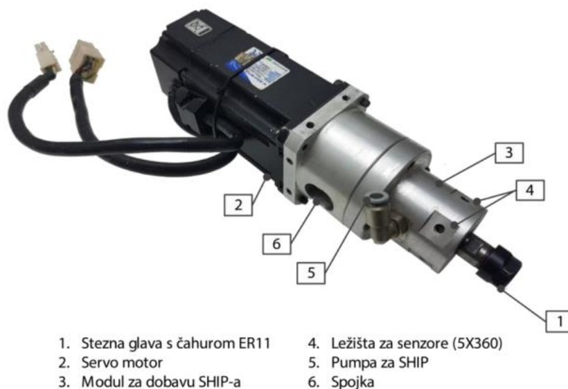
Slika 3.3. Modul glavnog prigona [3]
