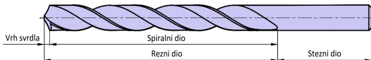
Slika 1.3. Dijelovi spiralnog svrdla [3]
