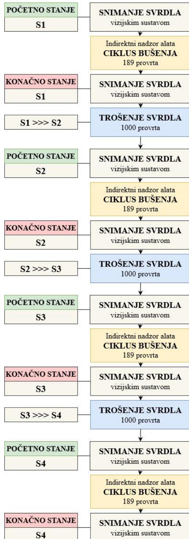
Slika 3.11. Tok određivanja stupnja istrošenosti alata [3,7]
