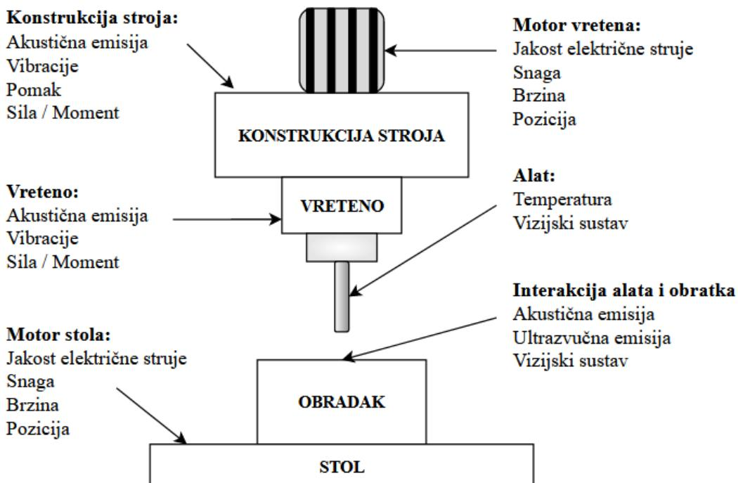
Slika 2.1. Uobičajeno nadzirane veličine pojedinih dijelova obradnog sustava [4]
