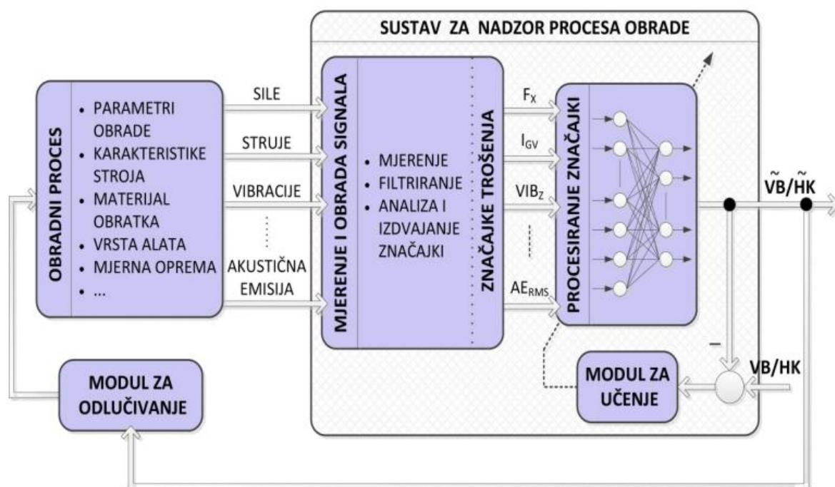
Slika 2.4. Model indirektnog nadzora obradnog procesa [3]
