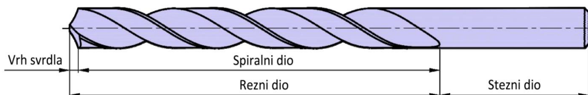
Slika 1.3. Dijelovi spiralnog svrdla [3]
