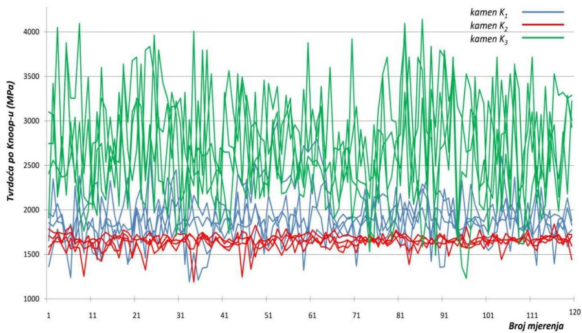
Slika 3.9. Izmjerene vrijednosti tvrdoće u ovisnosti o broju mjerjenja [3]
