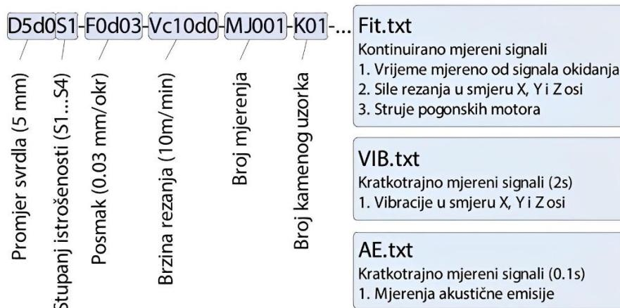
**Slika 3.8.** Primjer imena datoteke generiranog programskim paketom LabView [3]
