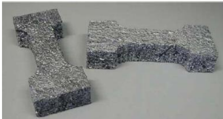
Slika 2.6 Uzorci za ispitivanje vlačne čvrstoće u obliku kosti [5]
