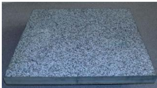
Slika 4.6. Grijaća ploča napravljena od Alporas ojačane pjene [5]
