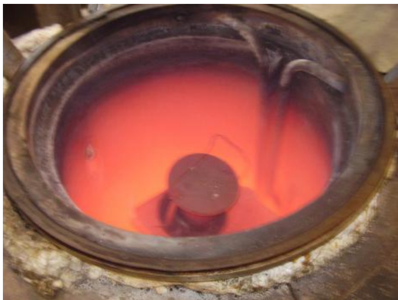
Slika 6.3. Kalup u peći na 850 Celzijusa
