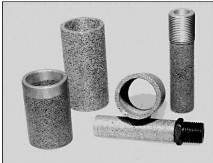
Slika 4.9. Prigušivači zvuka od aluminijskih pjena [3]
