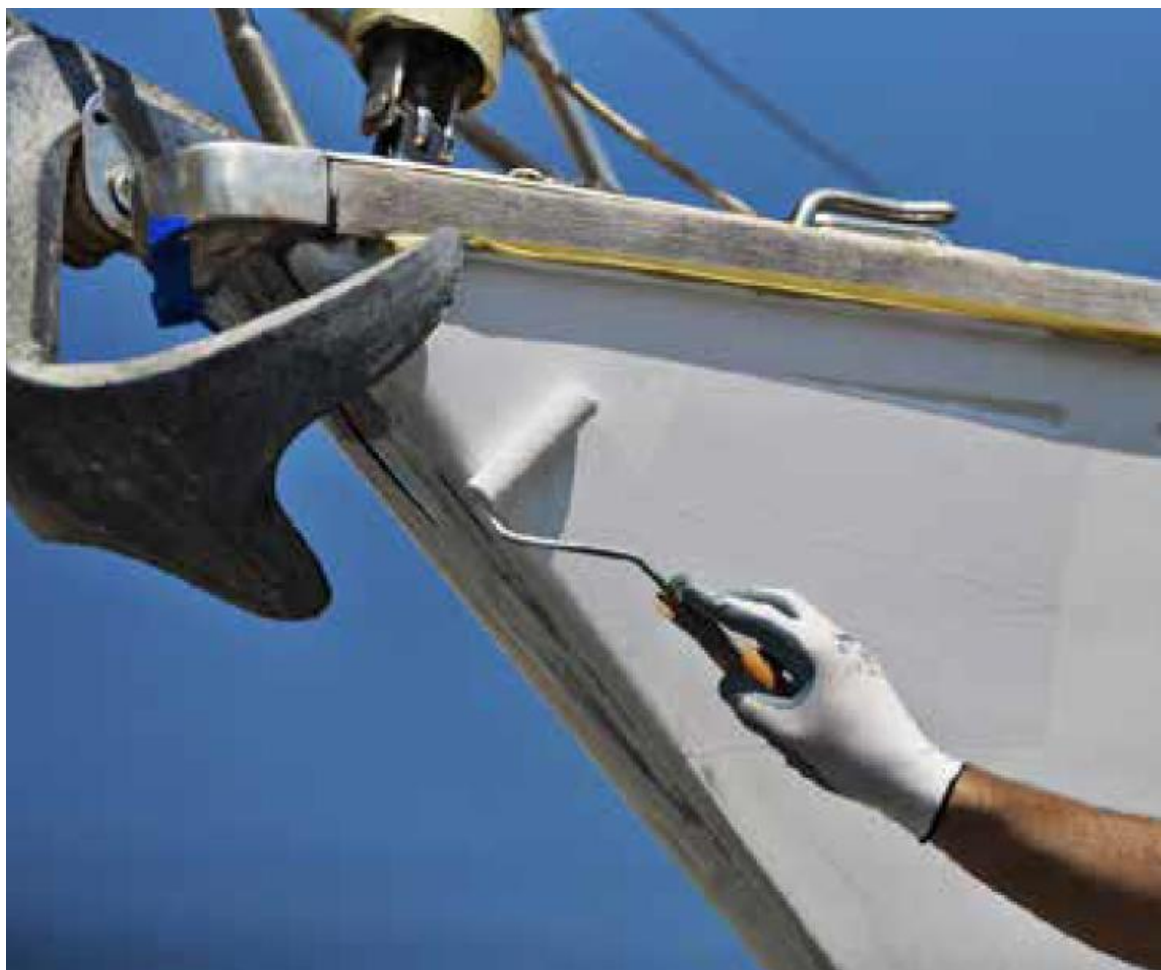
Slika 8. Nanošenje premaza valjkom [12]
