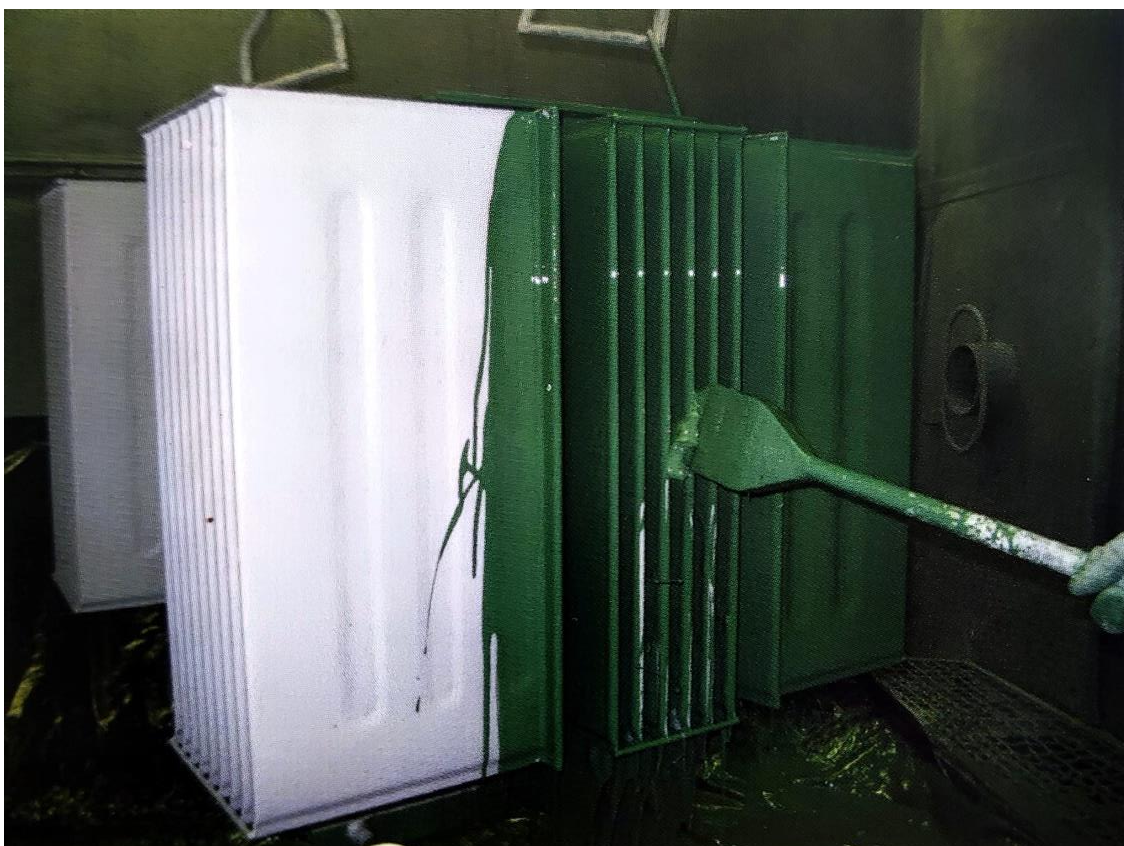
Slika 13. Nanošenje premaza prelijevanjem [3]
