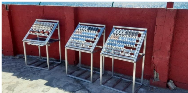
Slika 24. Korozijska stanica u Kaštel Sućurcu
