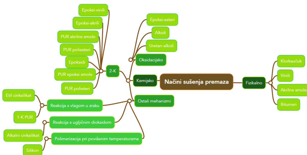
Slika 2. Podjela premaza s obzirom na način otvrdnjavanja [3]
