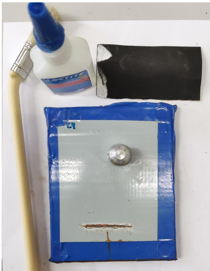
Slika 45. Pripor za pripremu površine i lijepljenje ispitnog valjka
