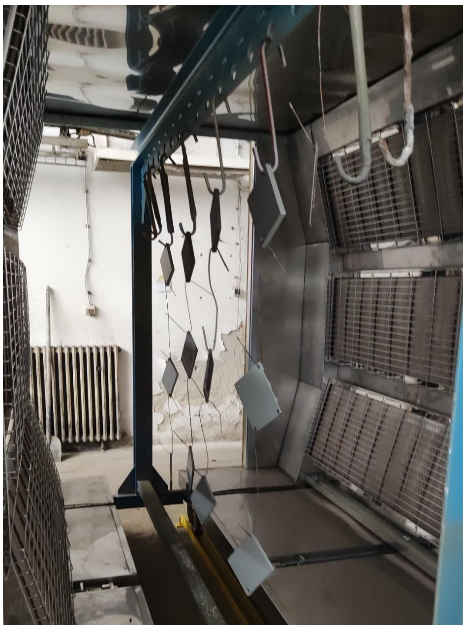
Slika 30. IC sušenje uzoraka, prototip kabine za IC sušenje premaza u tvrtki Končar – Metalne Konstrukcije
