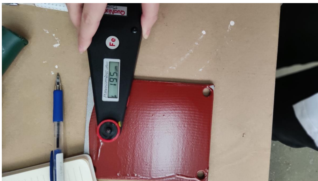
Slika 35. Mjerenje DSF temeljnog premaza
