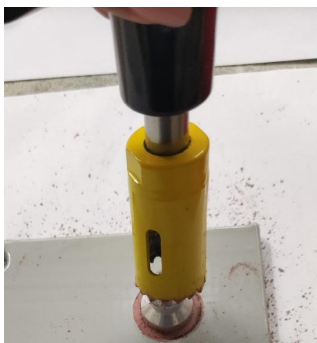
Slika 47. Skidanje ljepila oko dolija
