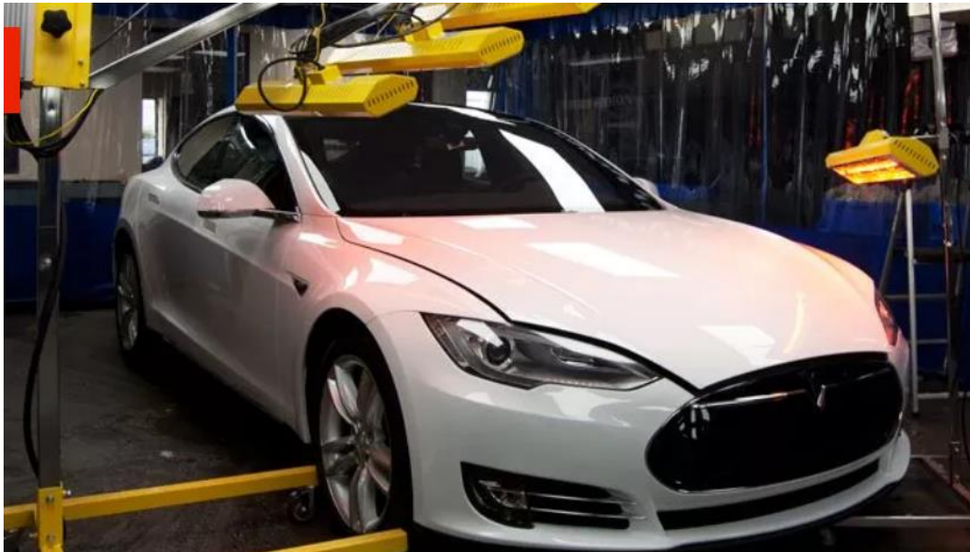
Slika 20. Primjena infracrvenog sušenja u automobilskoj industriji [22]
