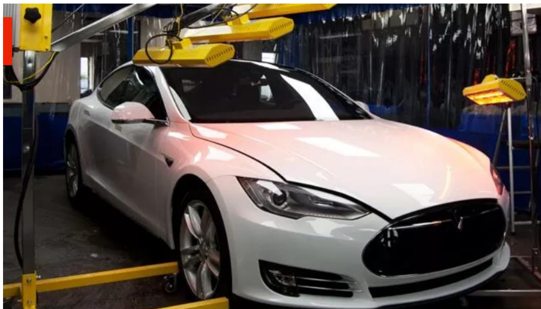
Slika 20. Primjena infracrvenog sušenja u automobilskoj industriji [22]
