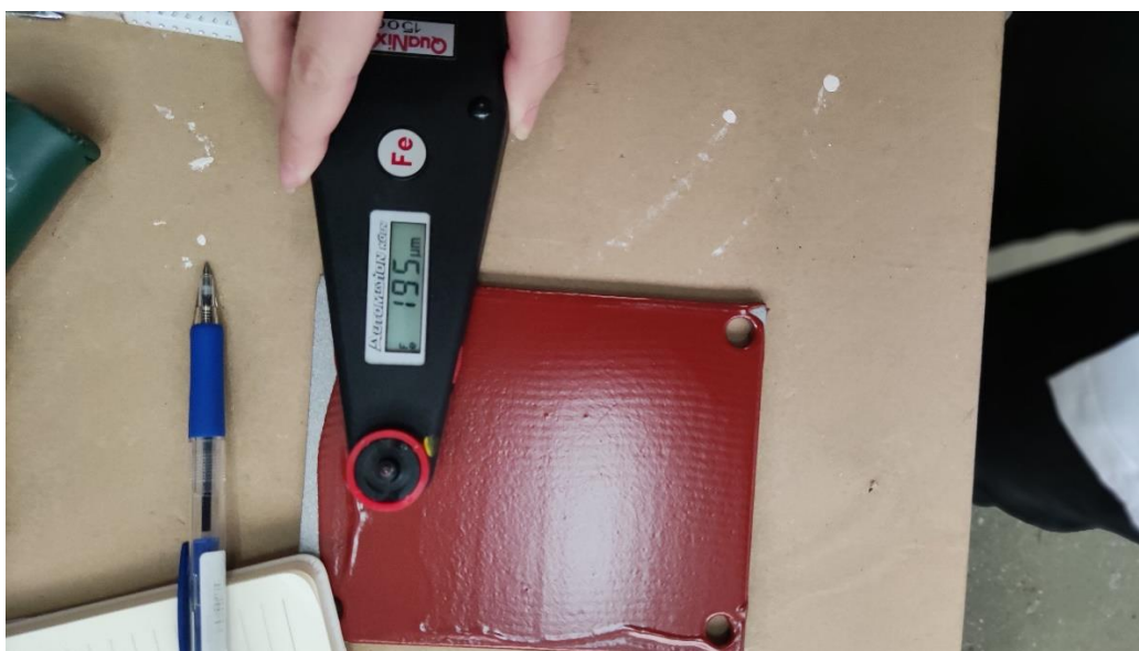
Slika 35. Mjerenje DSF temeljnog premaza
