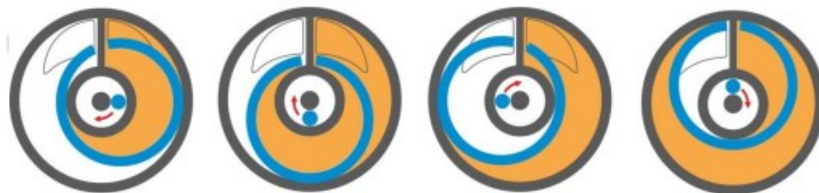
Slika 23. Prikaz principa rada diferencijalnog mjerača protoka [8]
