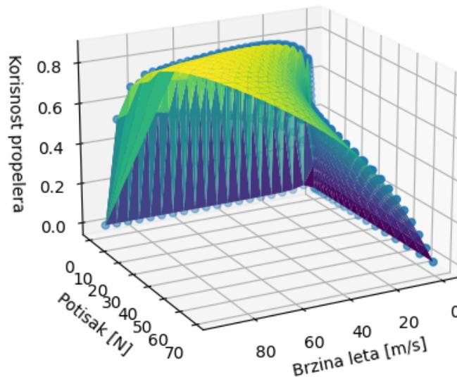
Slika 5.2: Ovisnost potiska, brzine leta i učinkovitosti propelera za 341 propeler
