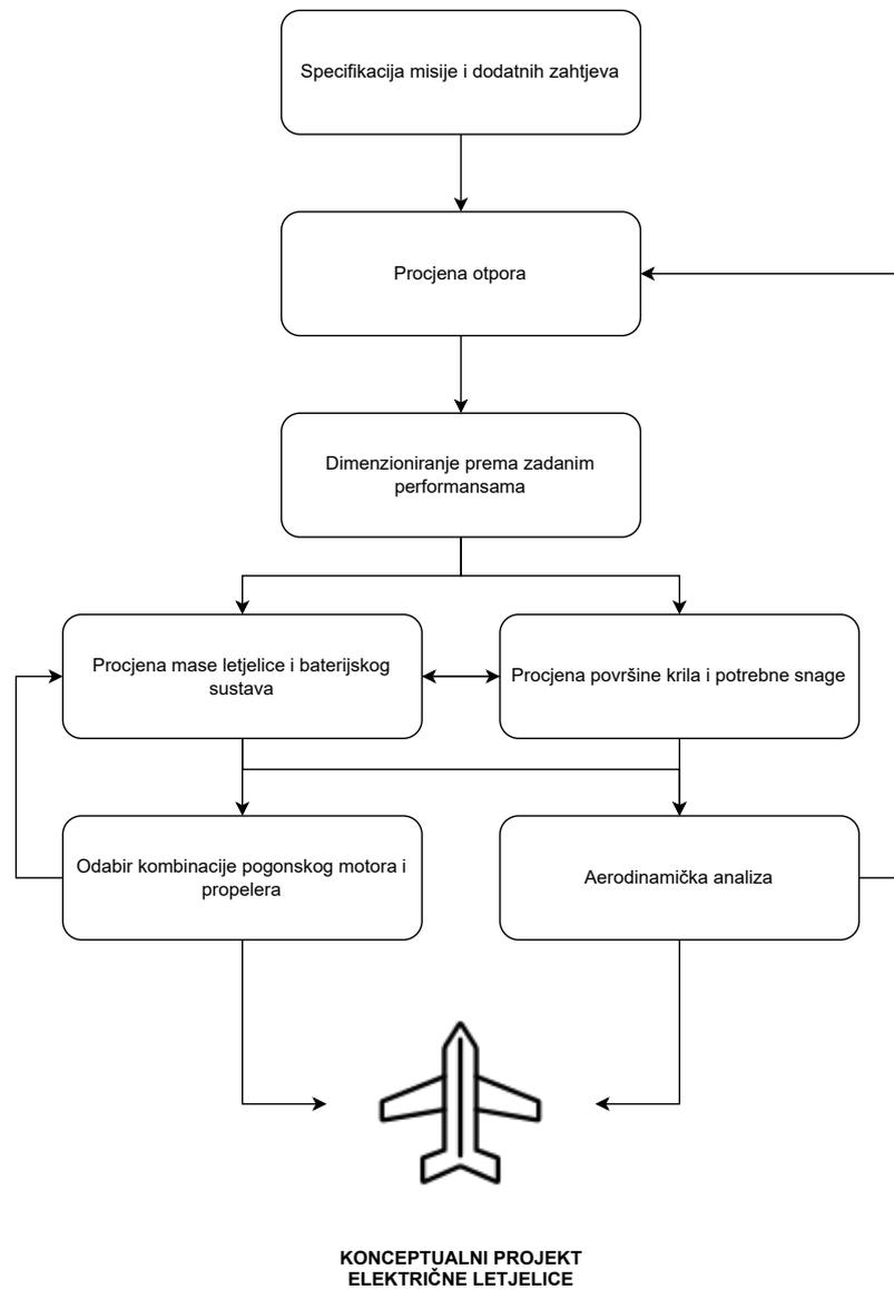
Slika 1.1: Pojednostavljena shema predloženog procesa projektiranja električnih letjelica
