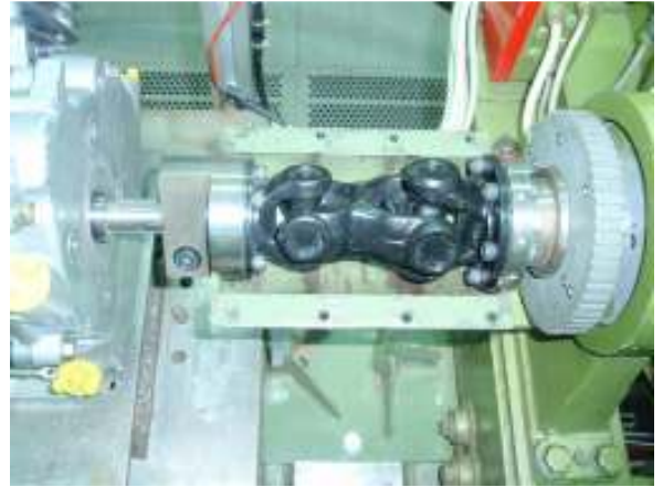
Slika 6.2. Montiranje spojnog vratila
