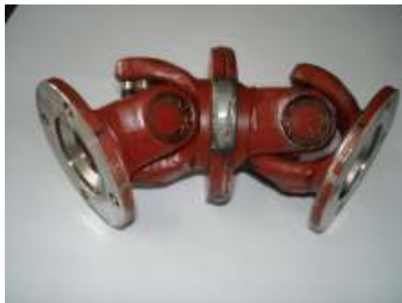
Slika 5.3. Postojeće spojno vratilo
