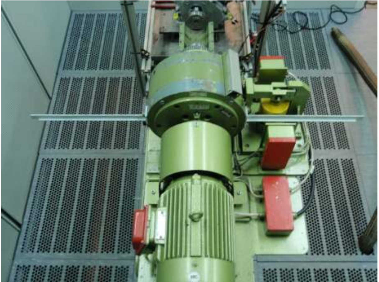
Slika 8.2. Montirane kalibracijske poluge
