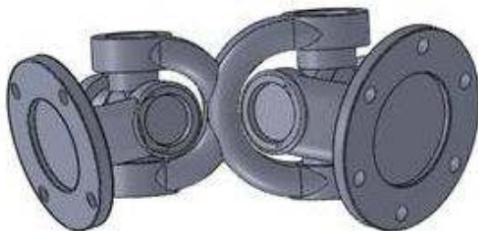
Slika 5.4. 3D model spojnog vratila
