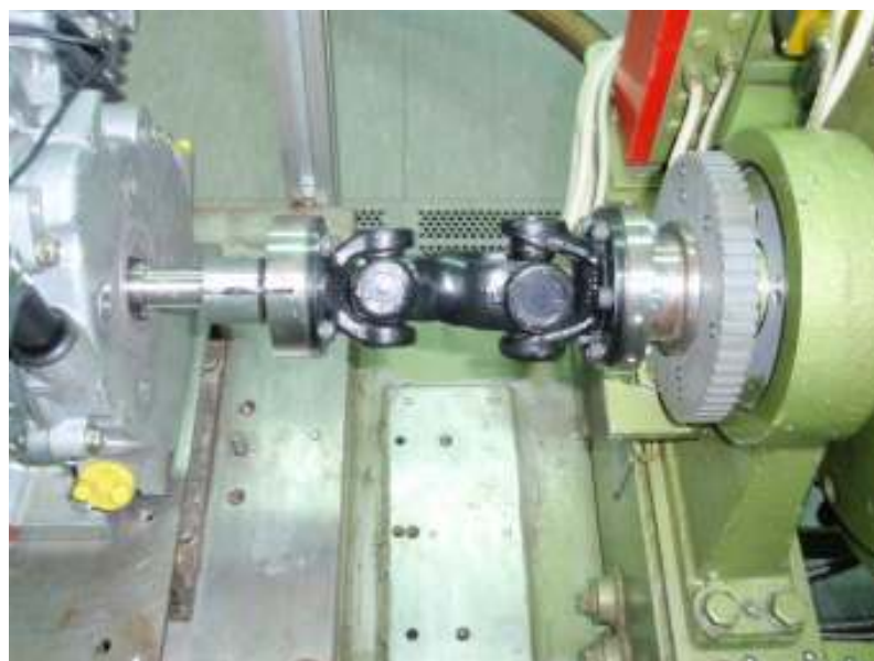
Slika 5.7. Montirano spojno vratilo na motor i kočnicu
