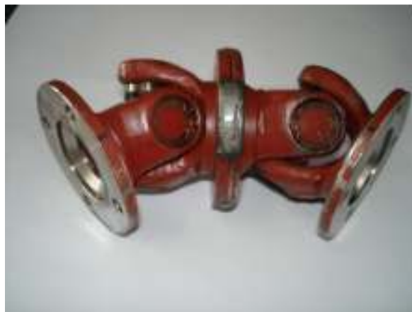
Slika 5.3. Postojeće spojno vratilo
