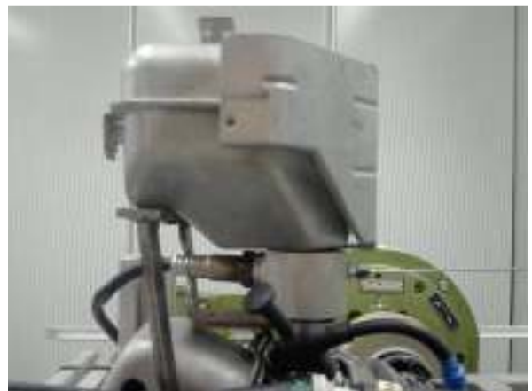
Slika 6.6. Spajanje lamdba sonde i termopara sa ispuhom
