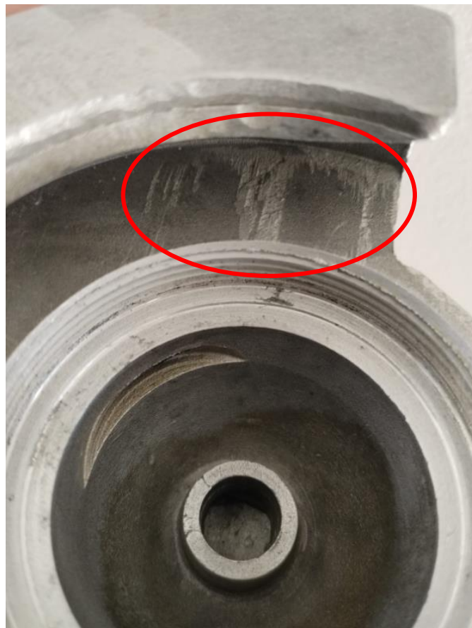
Slika 9. Ostrugana površina na odljevku uslijed zaribavanja alata
