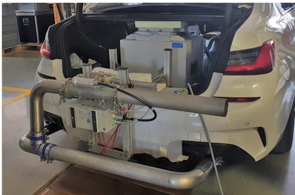
Slika 39. Mjerna oprema ugrađena u/na vozilo
