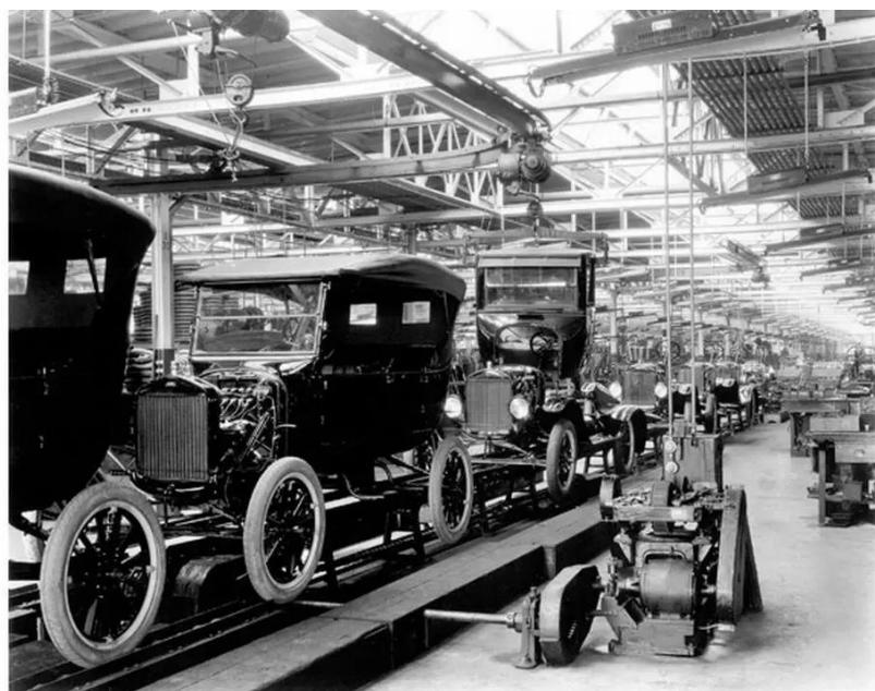
Slika 1. Prva pokretna traka za proizvodnju automobila tvrtke Ford Motor Company [2]
