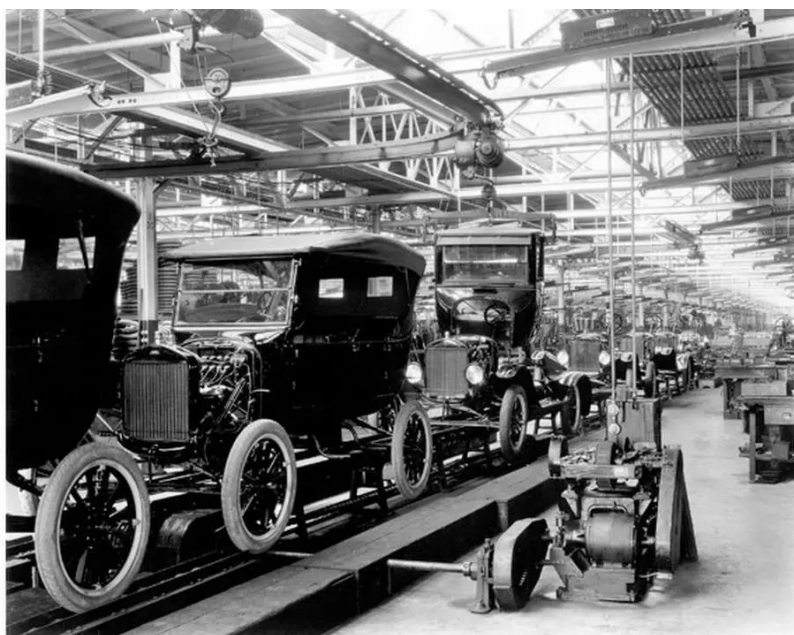
Slika 1. Prva pokretna traka za proizvodnju automobila tvrtke Ford Motor Company [2]
