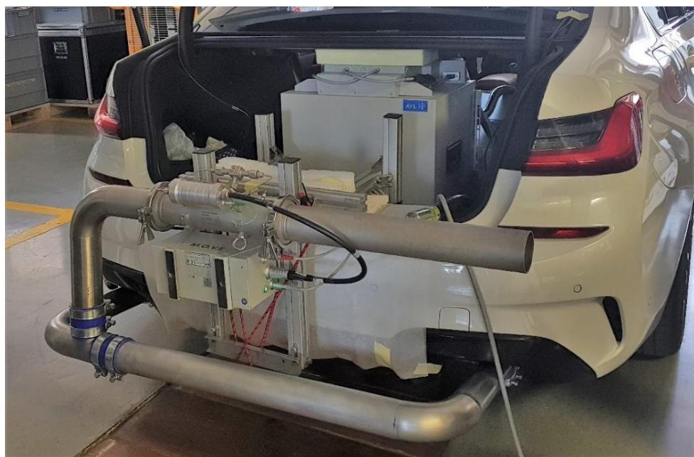
**Slika 39. Mjerna oprema ugrađena u/na vozilo**
