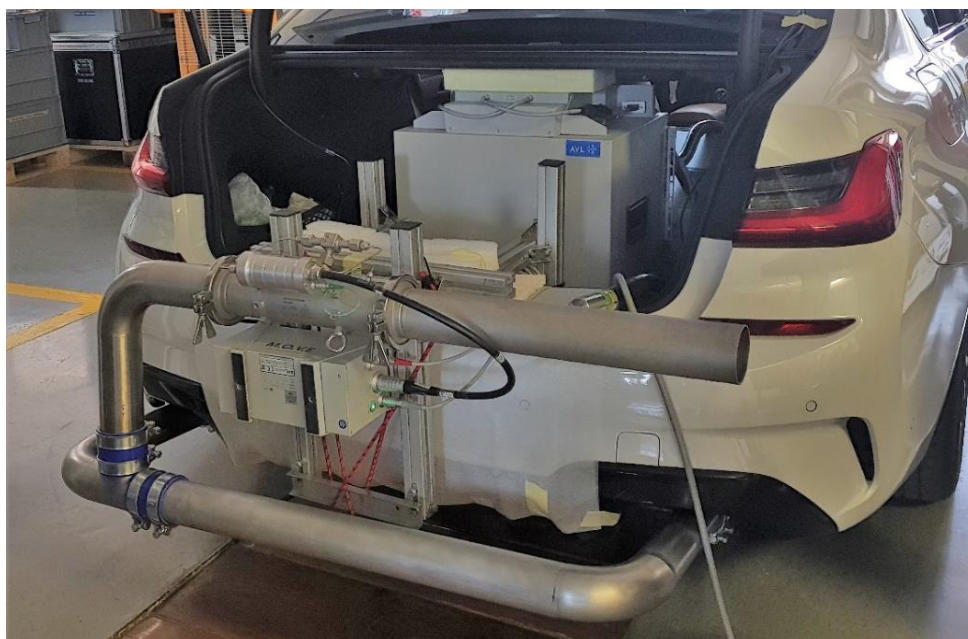
Slika 39. Mjerna oprema ugrađena u/na vozilo
