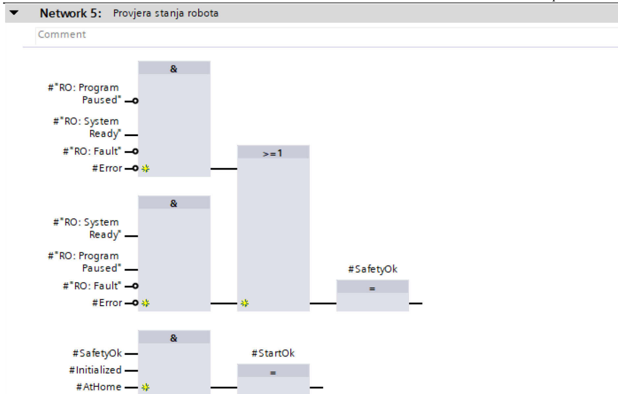
Slika 55. Logika za provjeru stanja Fanuc robota
