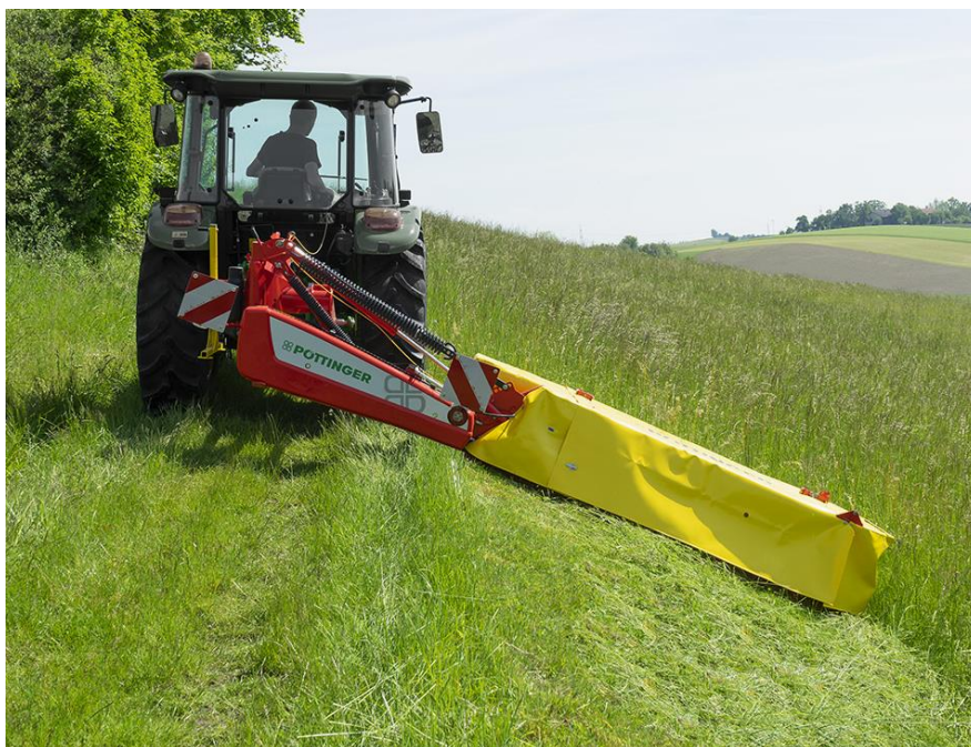
Slika 11. Rotacijska kosa PÖTTINGER NOVADISK 262
