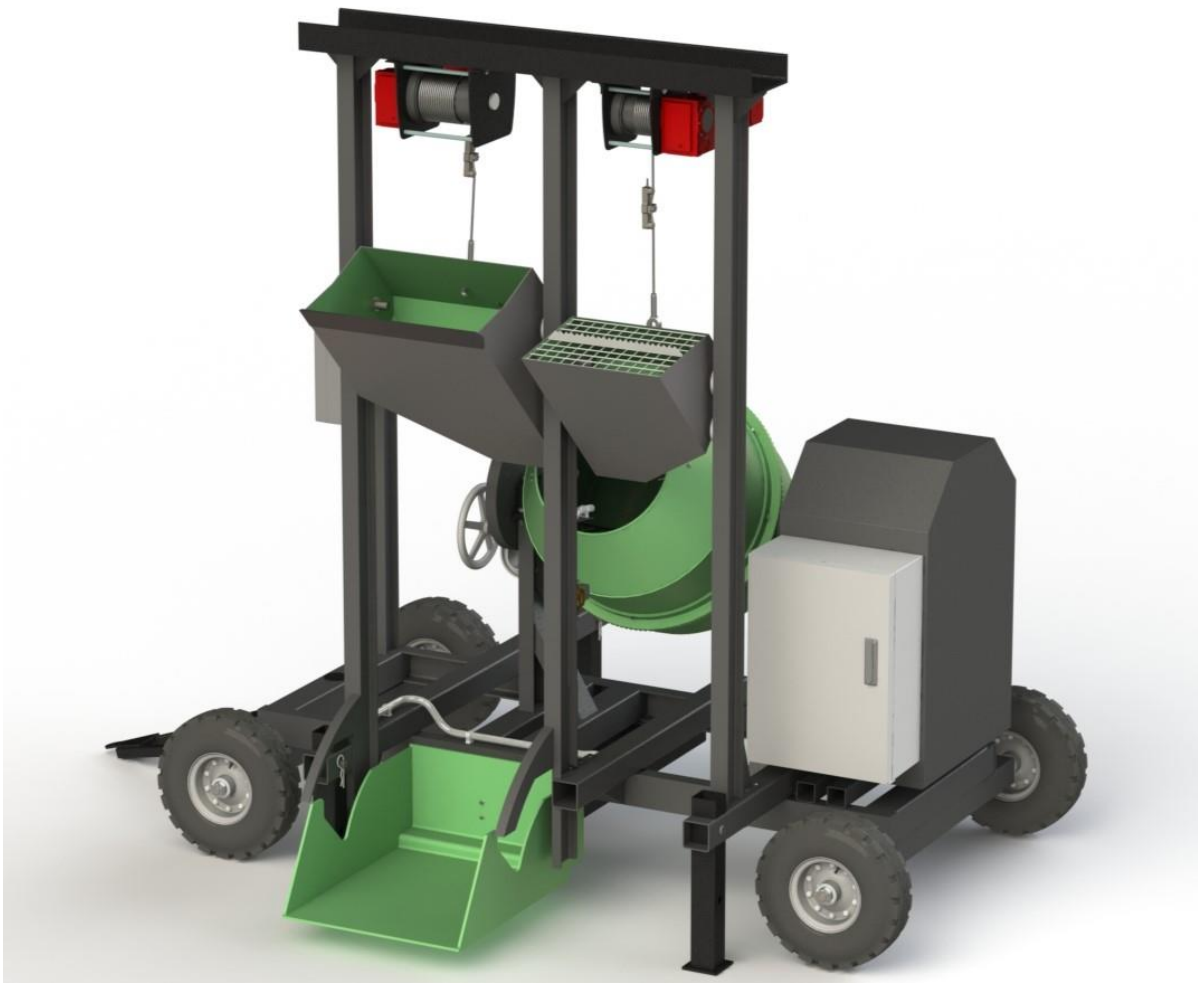
Slika 38. Mehanizam podizanja i spuštanja spremnika
