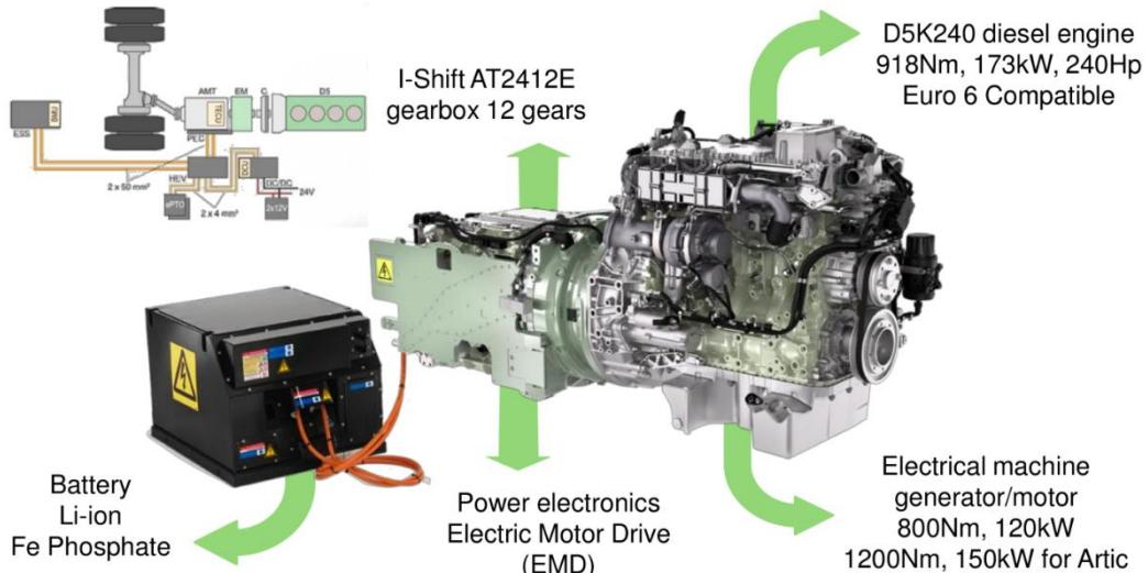
Slika 2-2. Detalji paralelnog pogonskog sklopa razmatranog PHEV-a [83].
