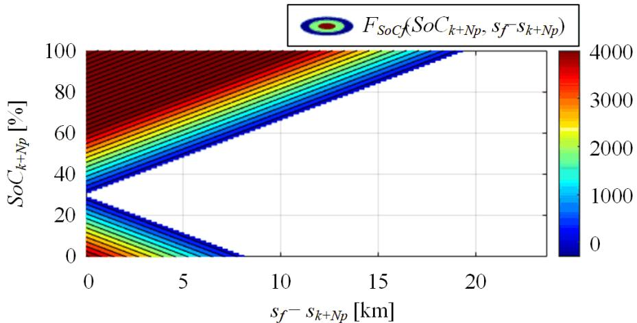
Slika 7-1. Ovisnost penalizacijskog člana  $F_{SoCf}$  o preostalom putu voznog ciklusa te o vrijednosti SoC-a na kraju predikcijskog horizonta.
