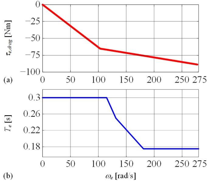
Slika 3-3. Karakteristika otpora isključenog Dieselovog motora (a) te vremenska konstanta dinamike motora pri porastu momenta, vezana uz dinamiku turbopunjača (b).
