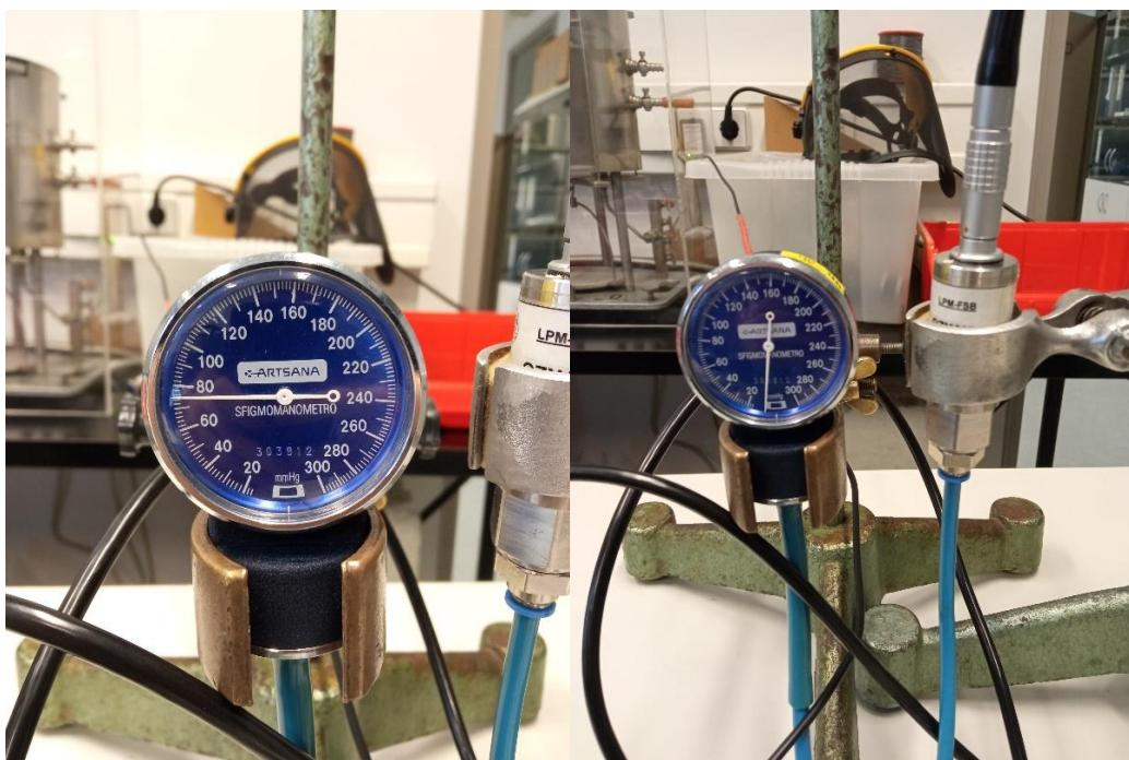
*Slika 24. Prikaz ispitivanog mehaničkog sfigmomanometra*
