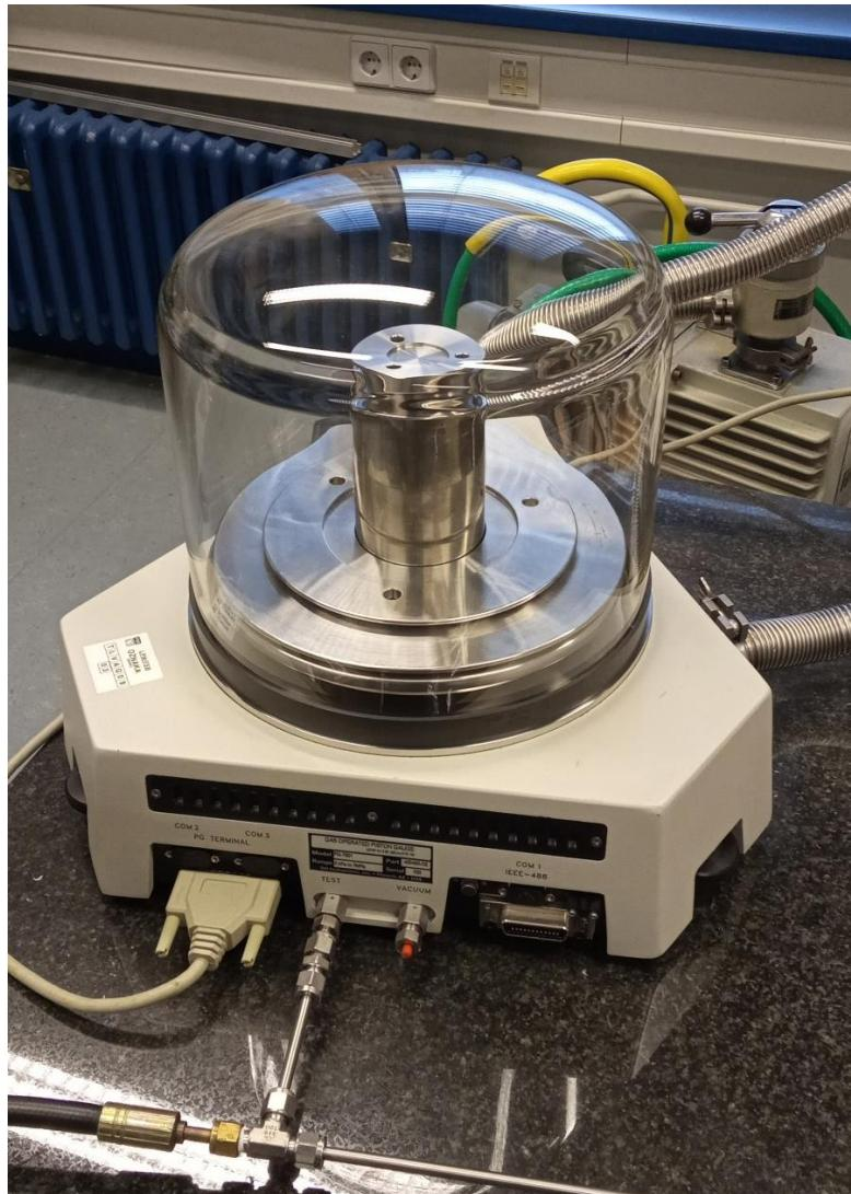
*Slika 23. Tlačna vaga (etalon)*
