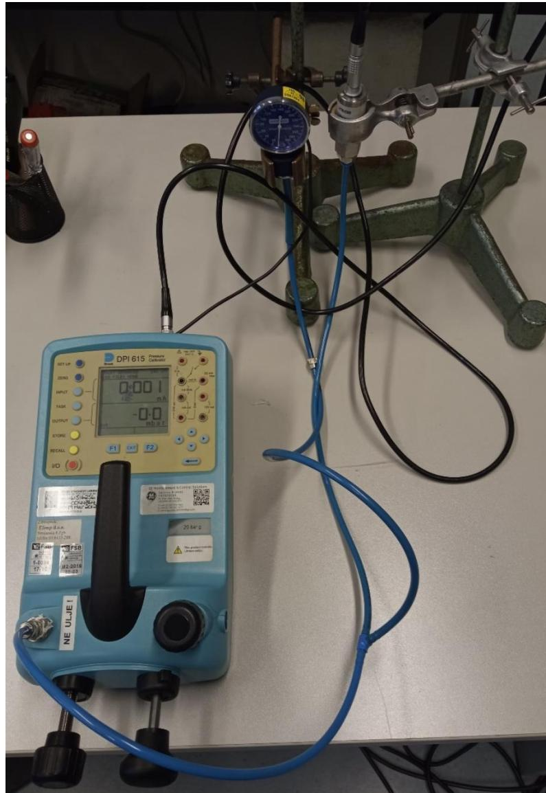
*Slika 25. Mjerna linija za ispitivanje sfigmomanometra s opružnim elementom*
