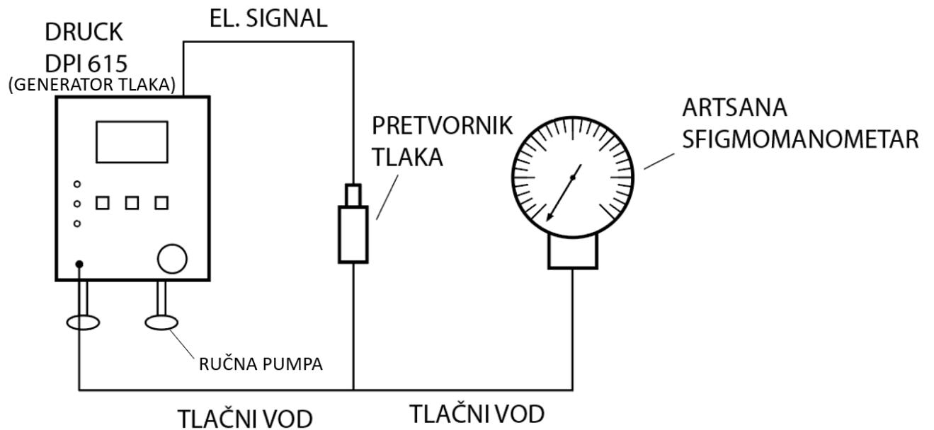
*Slika 26. Shema spajanja sfigmomanometra s opružnim elementom*
