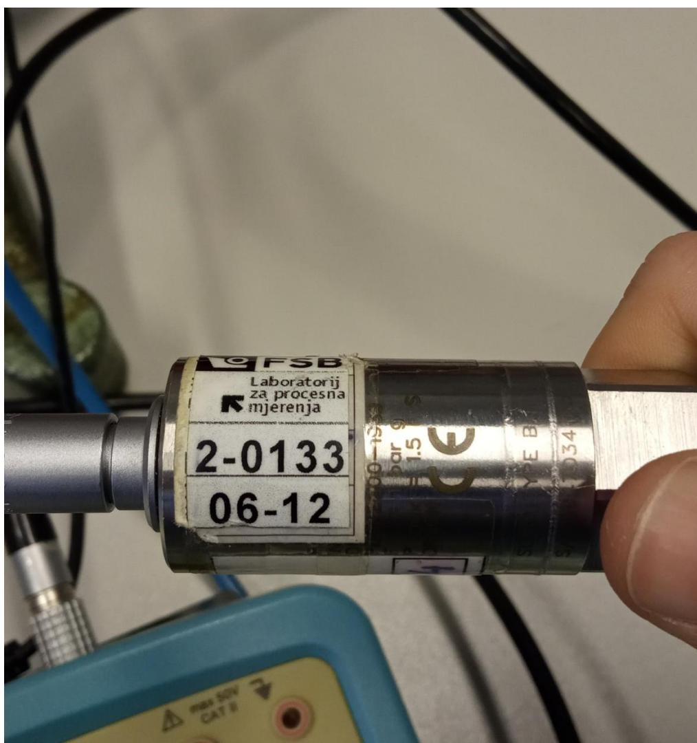
Slika 22. Pretvornik tlaka Druck (radni etalon)
