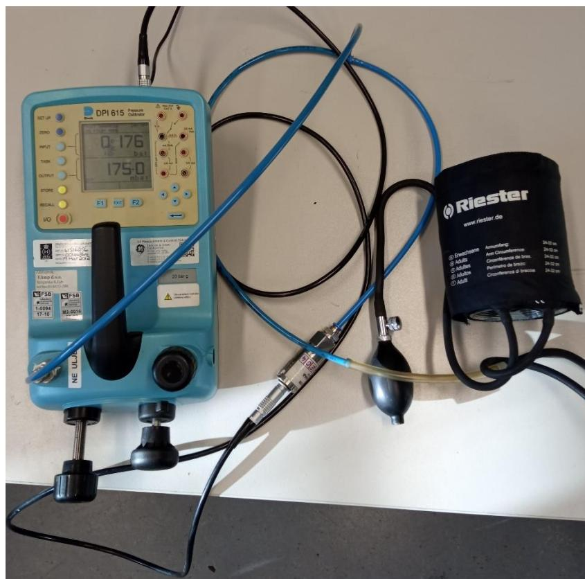
*Slika 31. Prikaz ispitne linije za ispitivanje manžetom*
