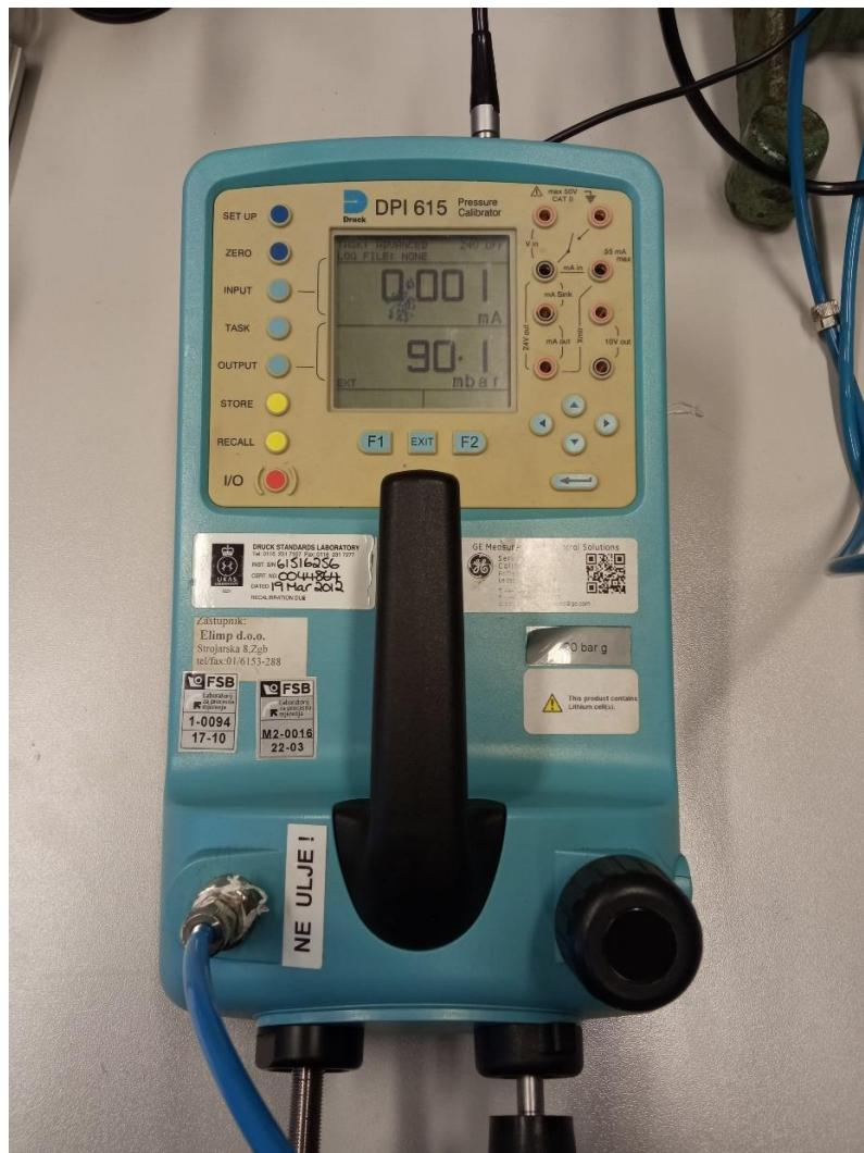
Slika 21. Kalibrator tlaka Druck DPI 615
