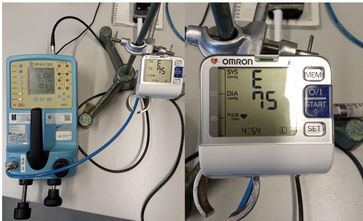
Slika 27. Mjerna linija s automatskim mjerilom tlaka
