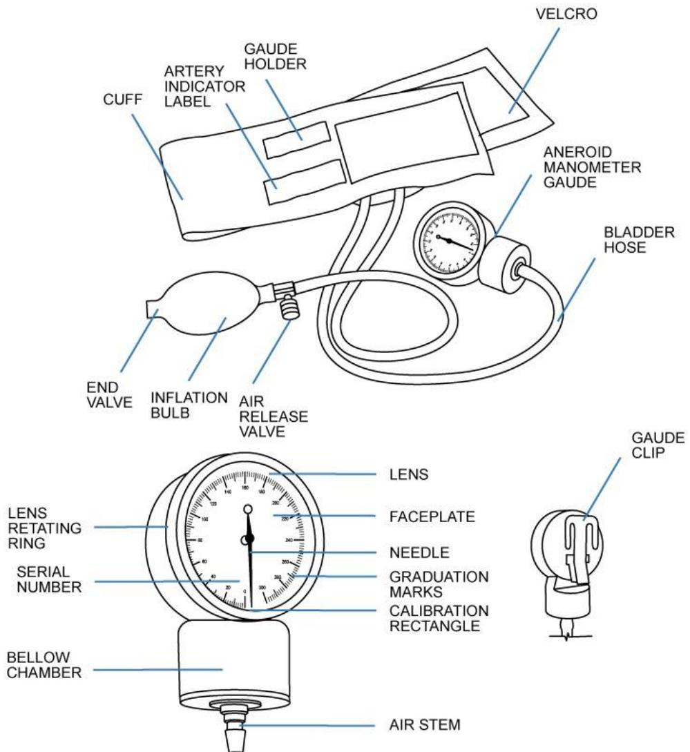
*Slika 17. Dijelovi mehaničkog sfigmomanometra s manžetom [26]*
