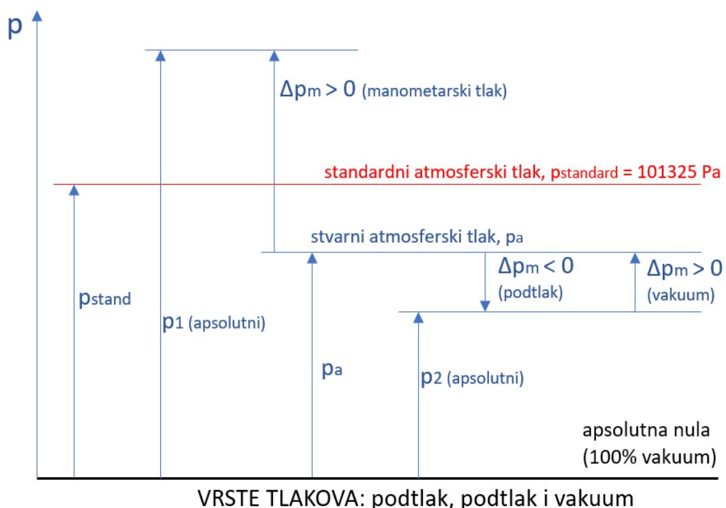
*Slika 1. Prikaz vrsta tlakova: pretlak, potlak i vakuum*
