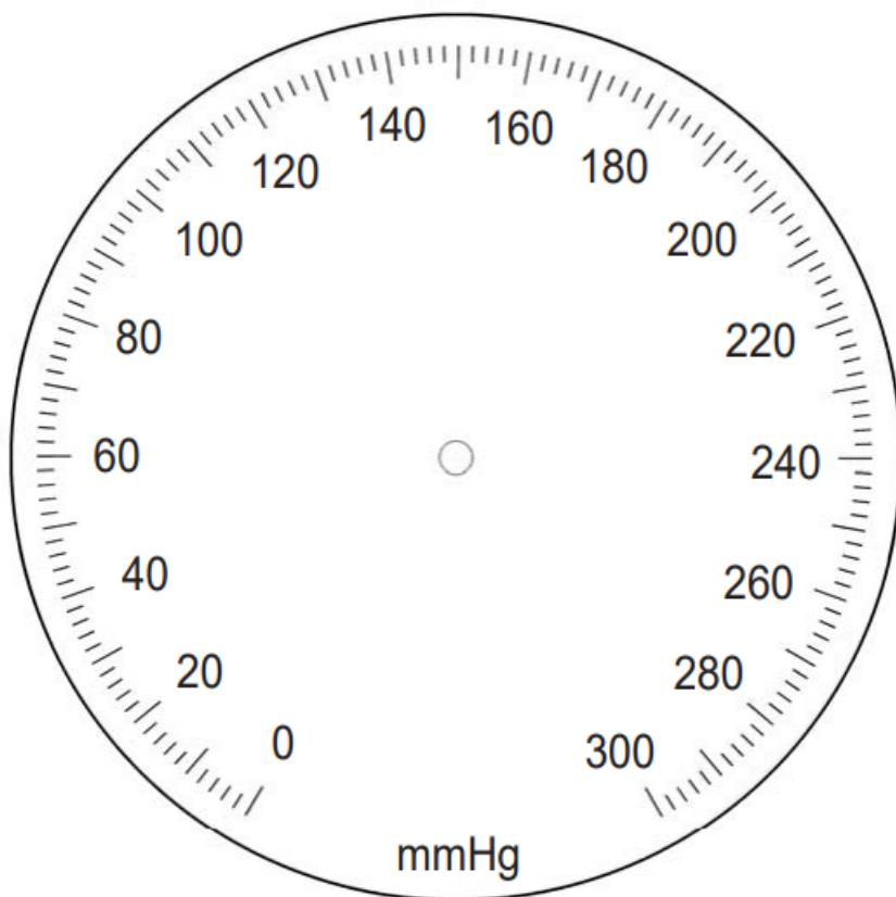
*Slika 19. Izgled zračnog pokazivača za merenje krvnog tlaka [7]*
