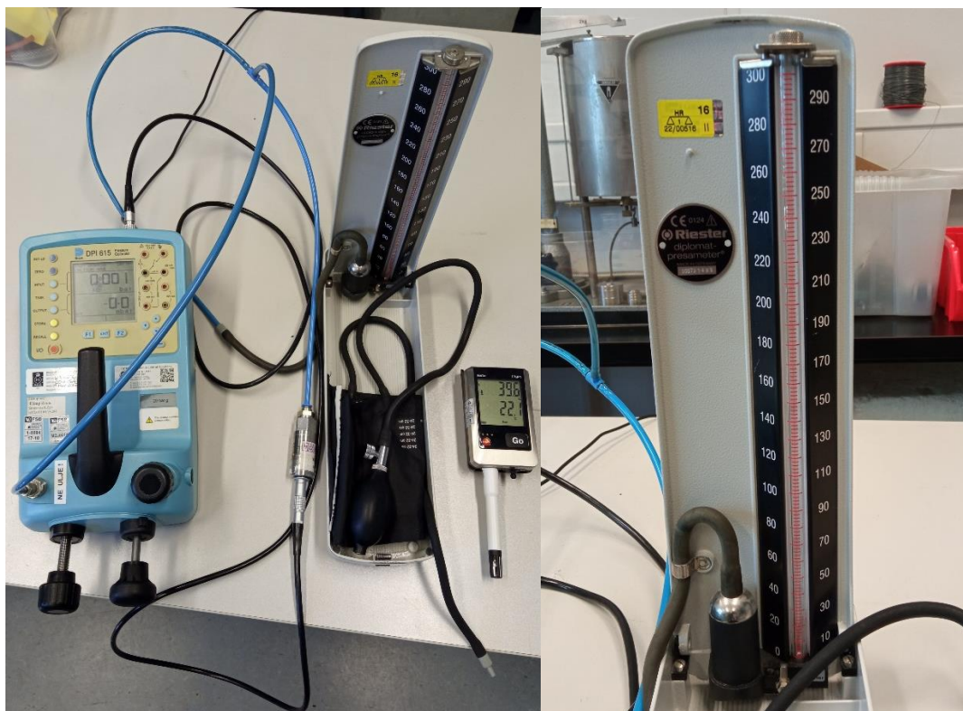
Slika 29. Prikaz ispitne mjerne linije i skale živinog sfigmomanometra
