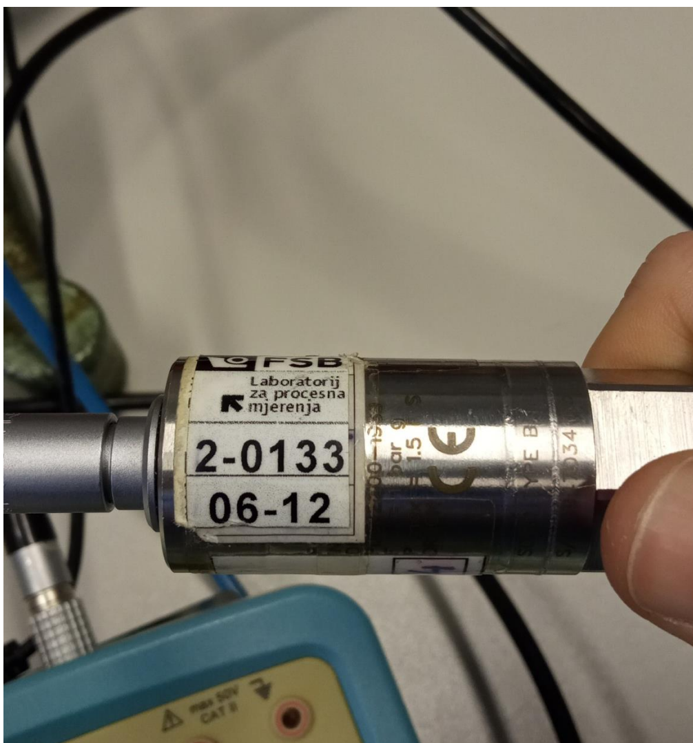
Slika 22. Pretvornik tlaka Druck (radni etalon)
