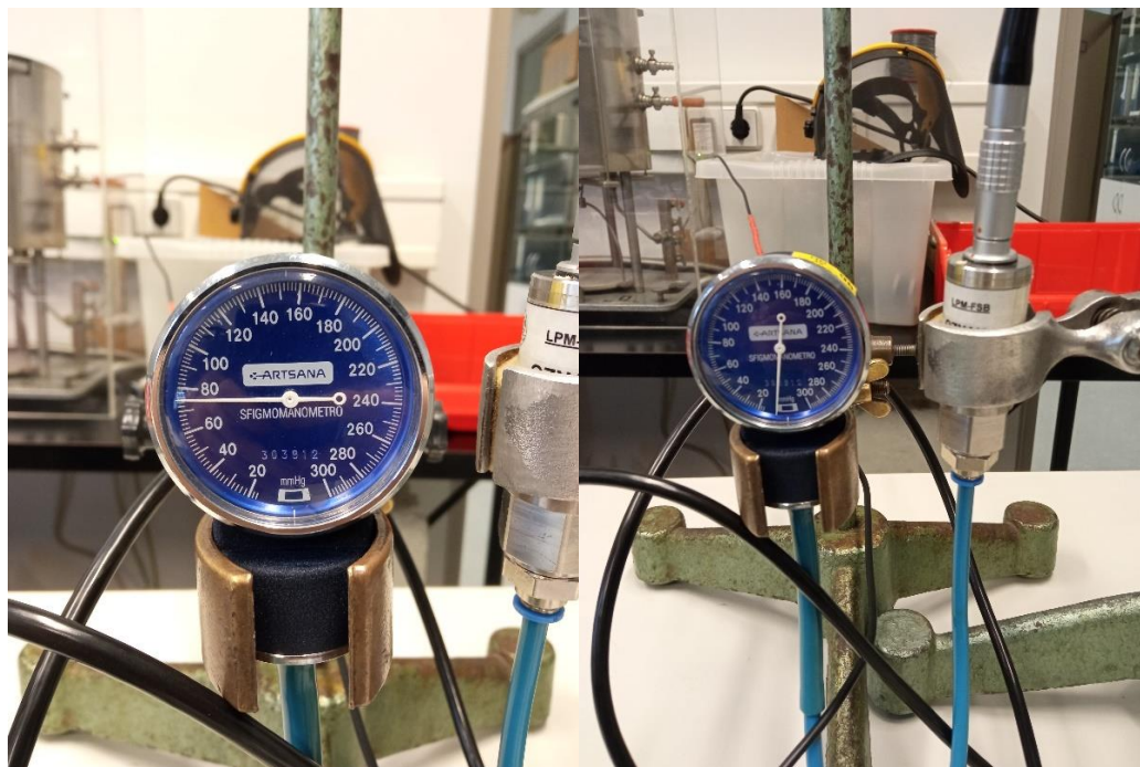
Slika 24. Prikaz ispitivanog mehaničkog sfigmomanometra
