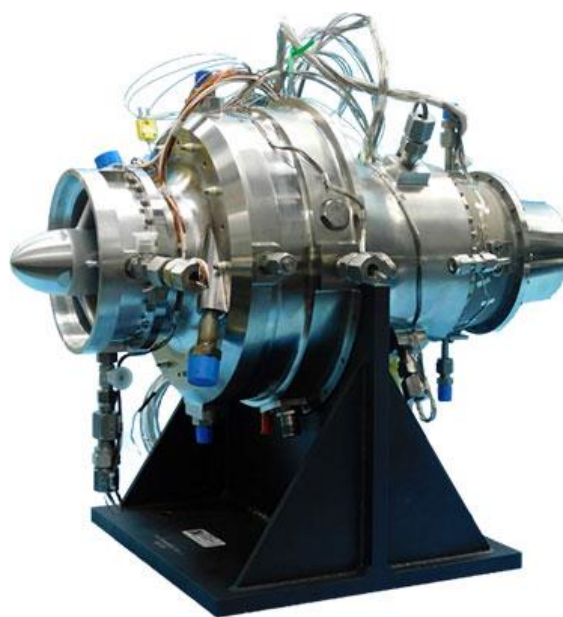
Slika 1.3. Turbomlazni motor Kratos za pogon letećeg projektila ili bespilotne letjelice [9]
