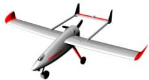
a) Bespilotna letjelica s fiksnim krilom
