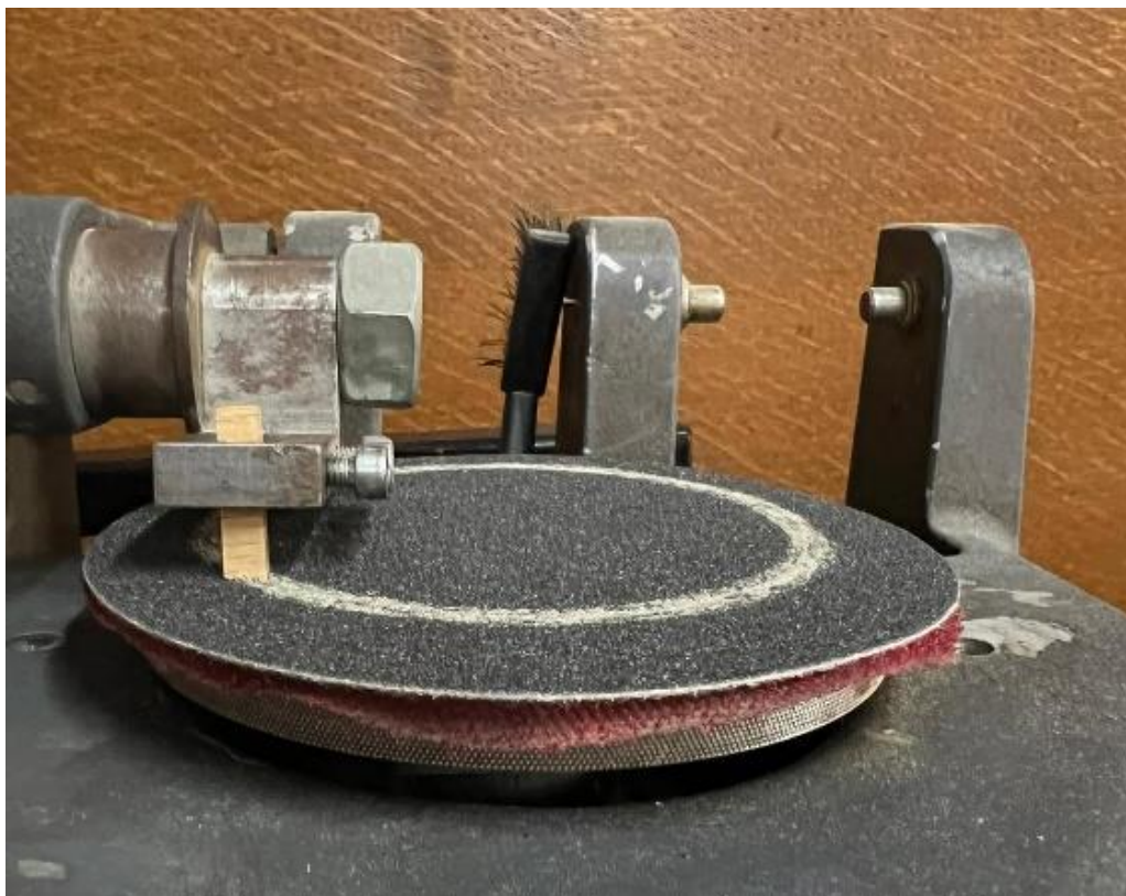
Slika 25. Ispitivanje abrazijske otpornosti na uređaju Taber abrader
