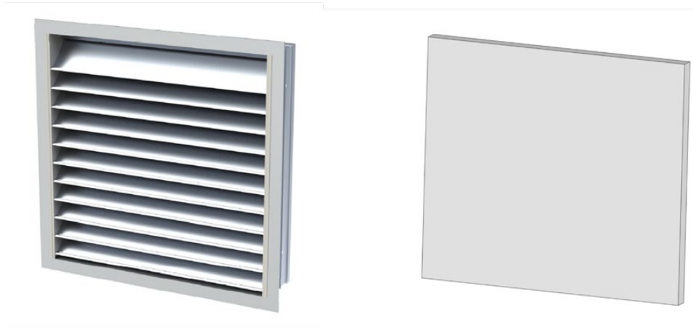
Slika 25. Pojednostavljena geometrija žaluzine
