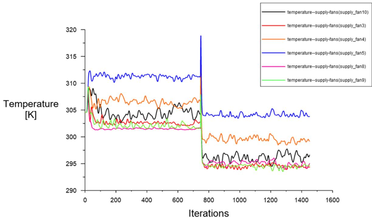
Slika 49. Uprosječene temperature na izlaznim centrifugalnim ventilatorima
