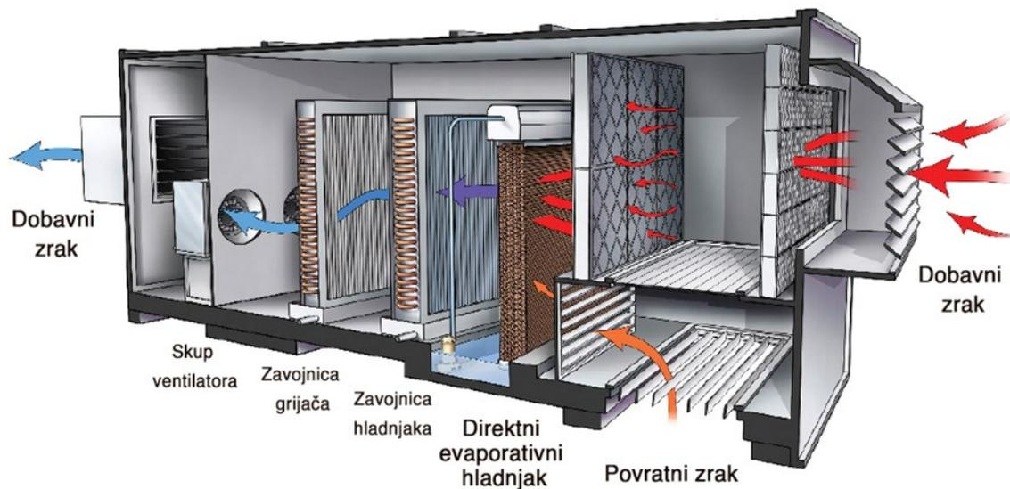
Slika 14. Konfiguracija klimatizacijske jedinice s direktnim evaporativnim hladnjakom [19]
