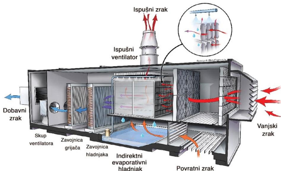
Slika 15. Konfiguracija klimatizacijske jedinice s indirektnim evaporativnim hladnjakom [19]
