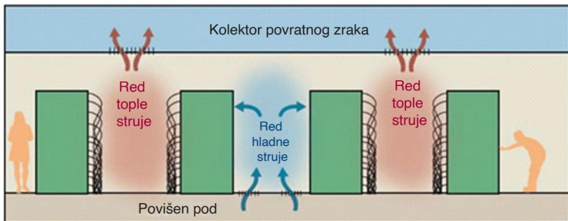
Slika 7. Konfiguracija podatkovnog centra sa spuštenim stropom
