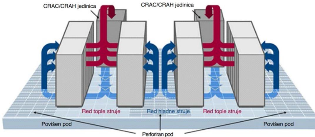
Slika 6. Konfiguracija podatkovnog centra bez spuštenog stropa
