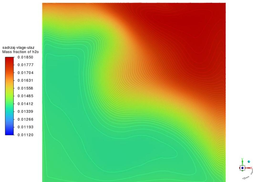
Slika 38. Konture sadržaja vlage izlazne površine hladnjaka
