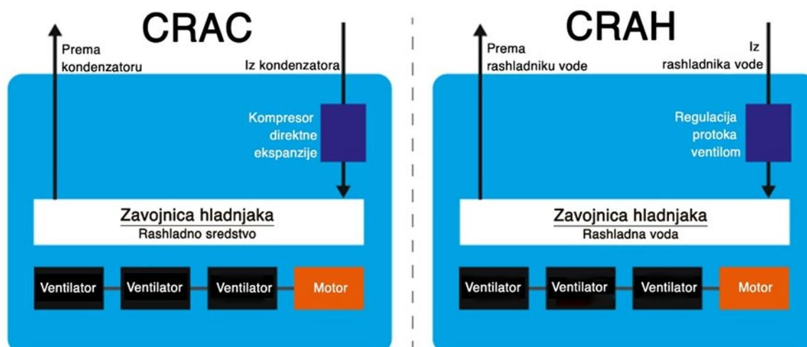
Slika 5. Usporedba rada CRAC i CRAH jedinica
