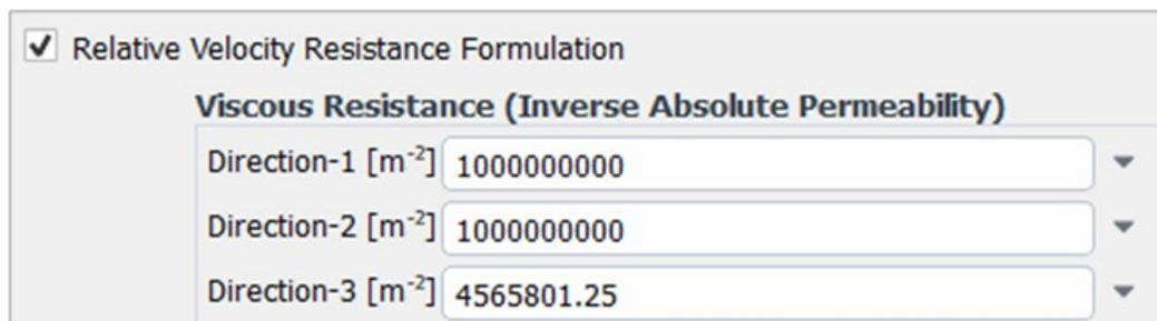
Slika 32. Koeficijenti obrnuto proporcionalne permeabilnosti filtera  $1/\alpha$
