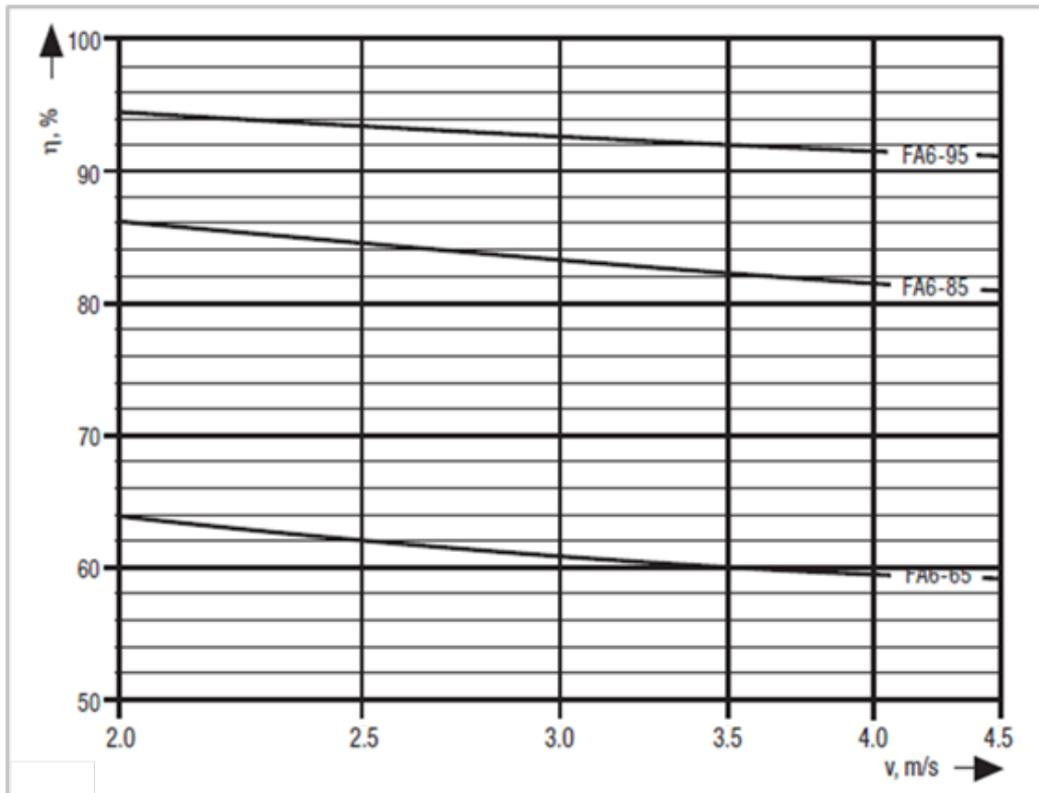
Slika 33. Ovisnost učinkovitosti o brzini nastrujavanja na hladnjak [19]
