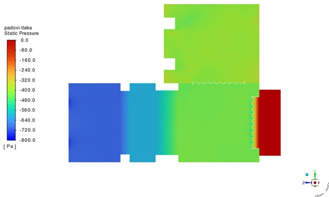
Slika 53. Konture padova tlaka u klimatizacijskoj jedinici
