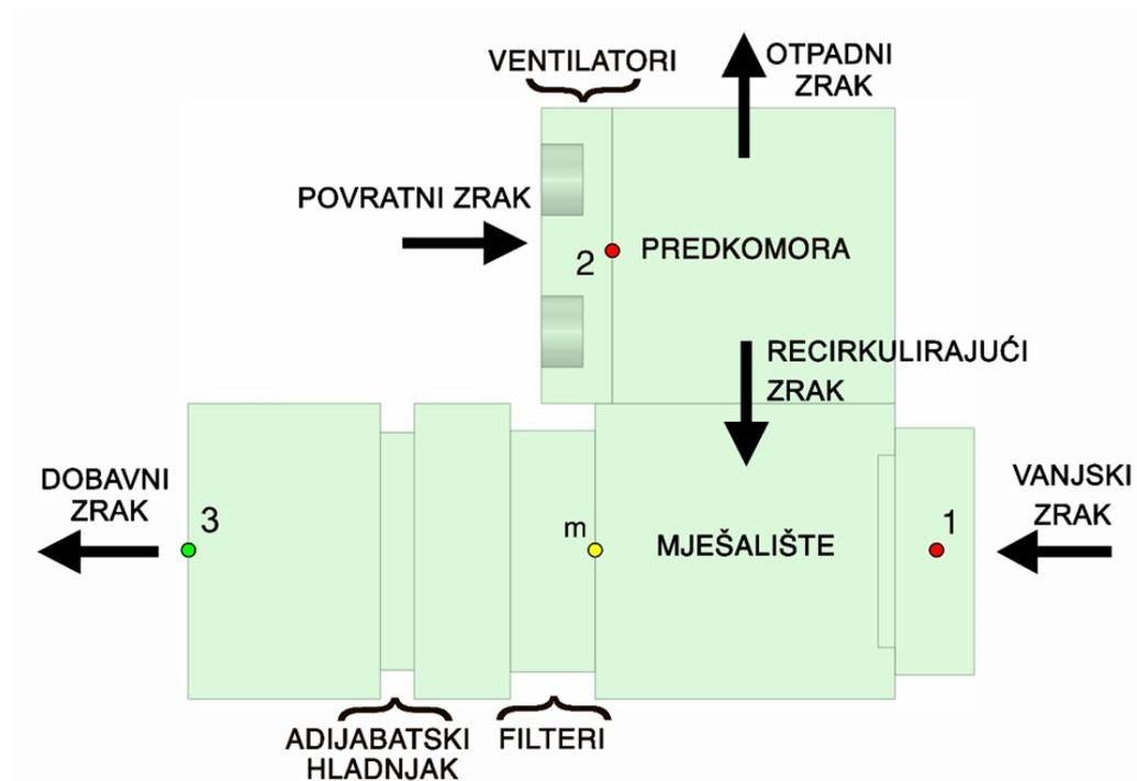
Slika 18. Smještaj komponenti i princip rada analizirane klimatizacijske jedinice
