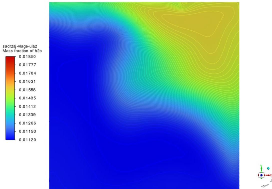
Slika 37. Konture sadržaja vlage ulazne površine hladnjaka
