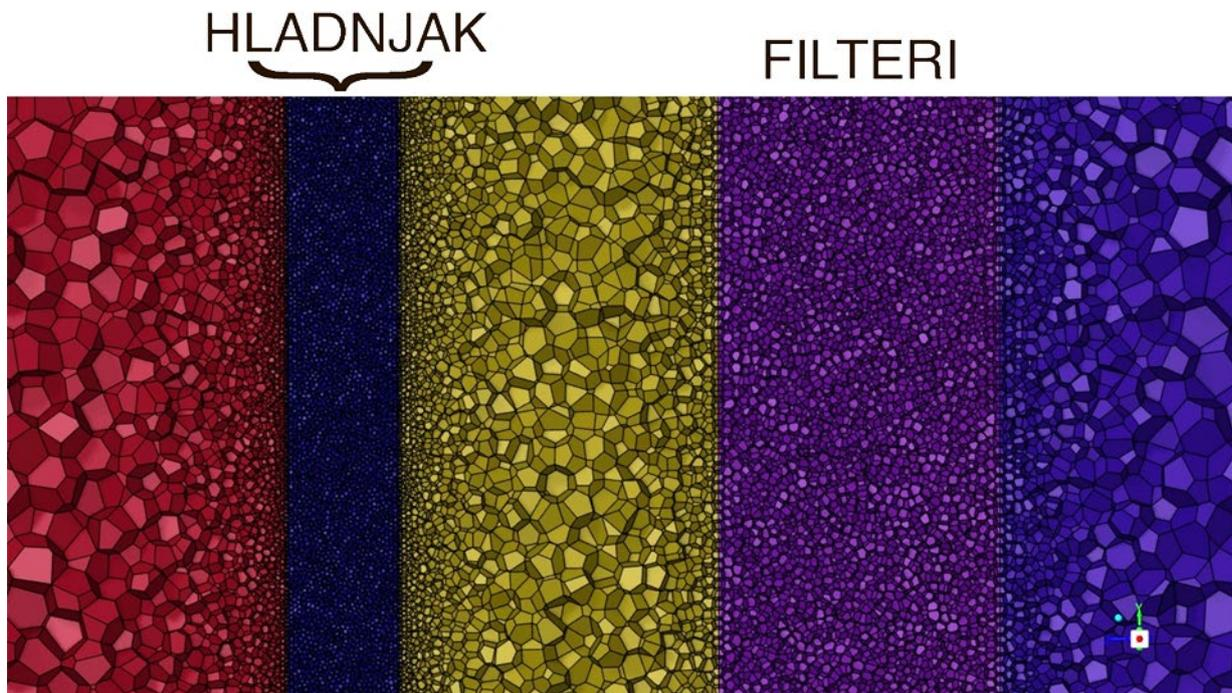
Slika 29. Volumensko lokalno dimenzioniranje hladnjaka i filtera
