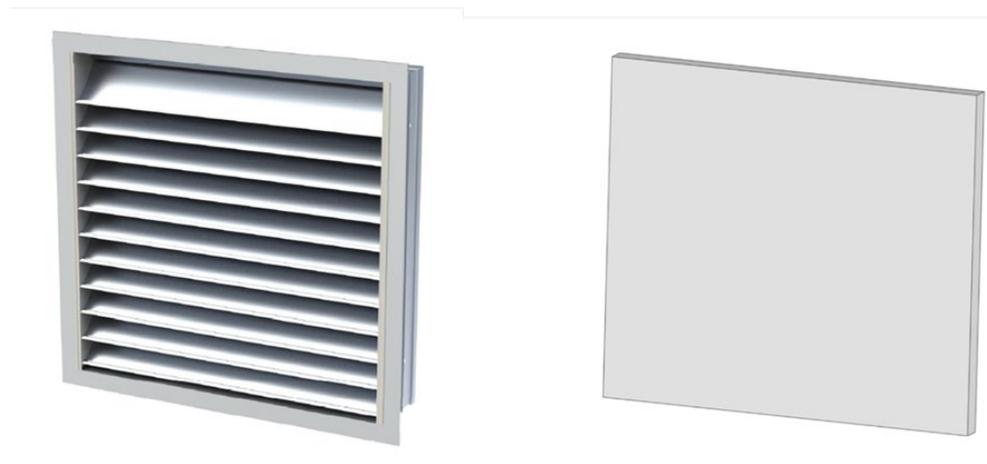
Slika 25. Pojednostavljena geometrija žaluzine
