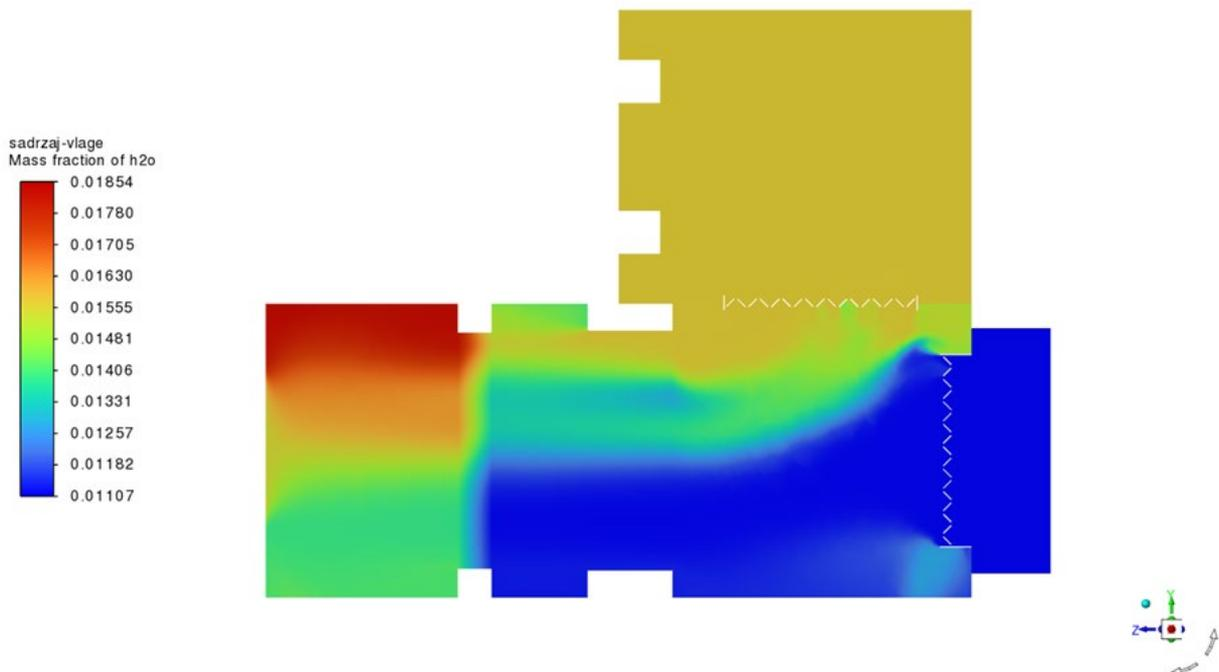
Slika 39. Konture sadržaja vlage u klimatizacijskoj jedinici
