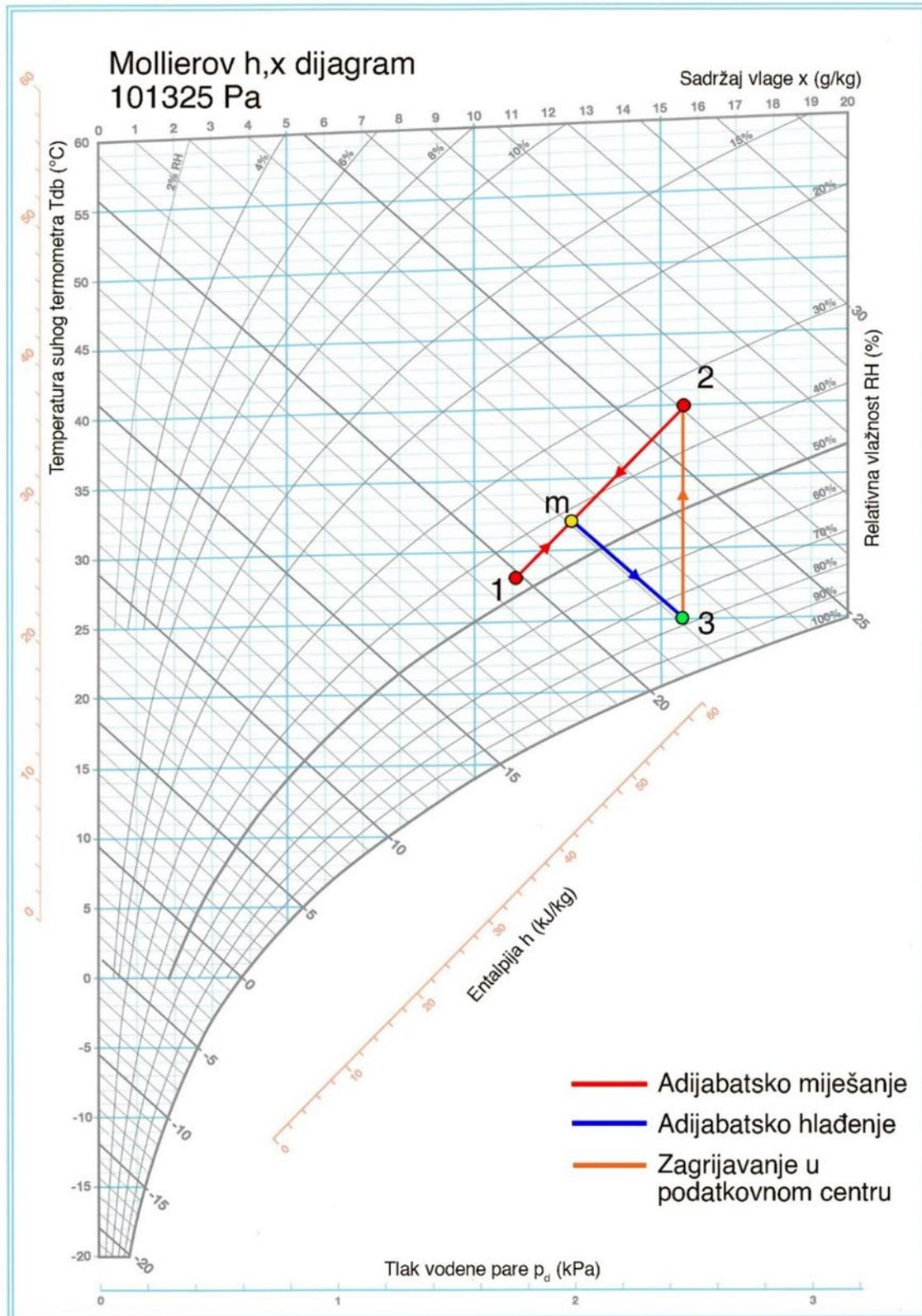
Slika 19. Stanja zraka klimatizacijske jedinice u Molierovom dijagramu
