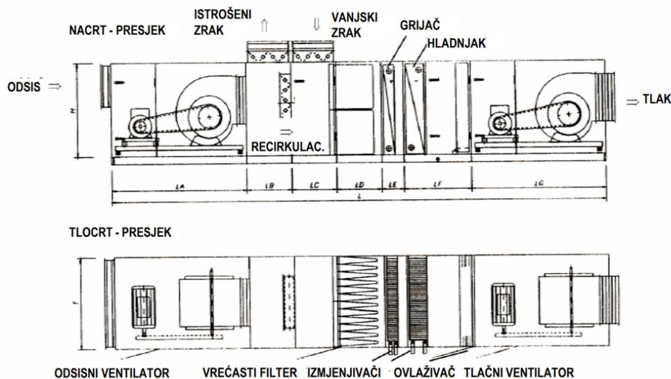
Slika 9. Presjek klimatizacijske jedinice i njenih komponenti [15]
