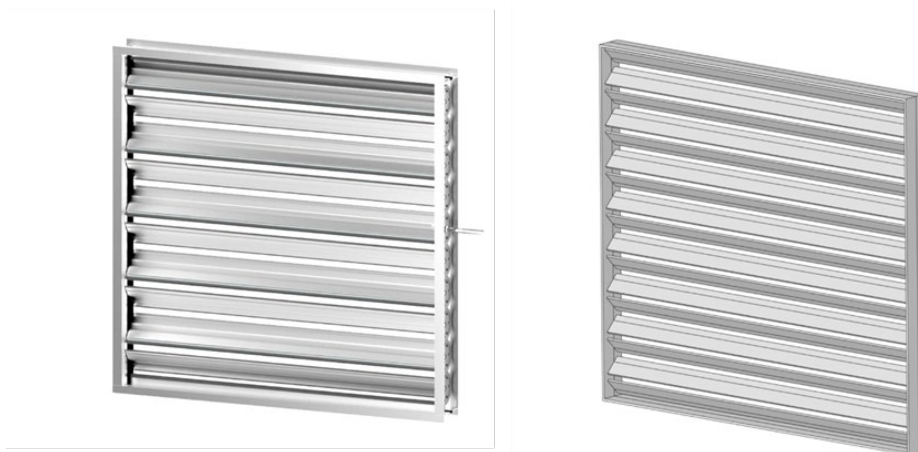
Slika 21. Pojednostavljenje geometrije zaklopke
