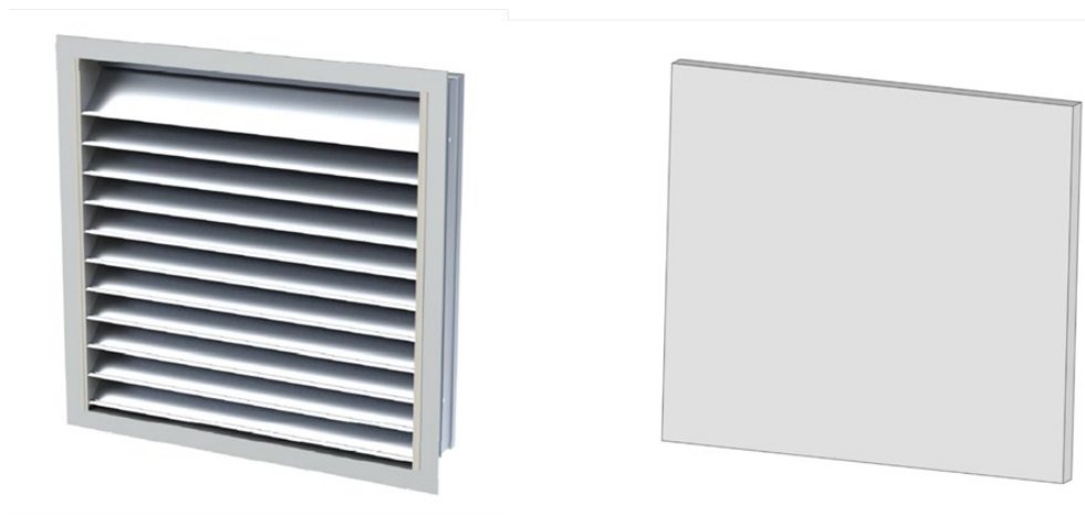
Slika 25. Pojednostavljena geometrija žaluzine
