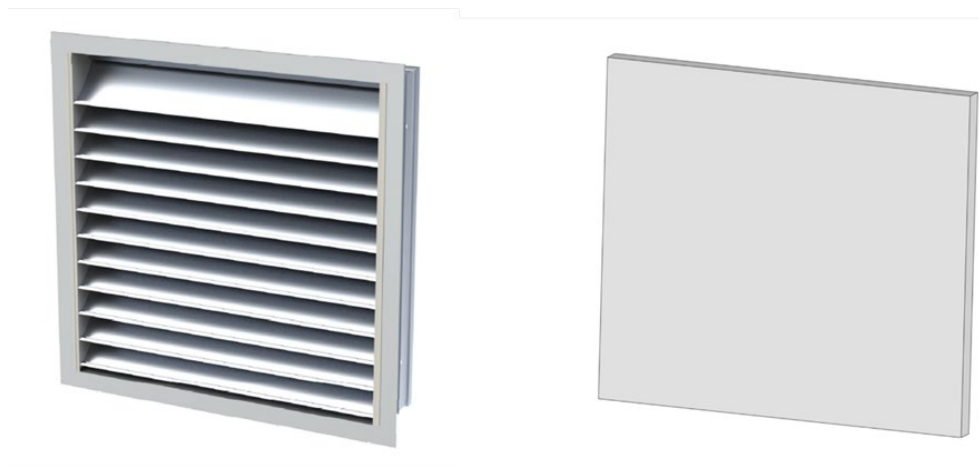
Slika 25. Pojednostavljena geometrija žaluzine
