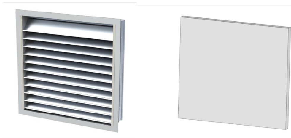
Slika 25. Pojednostavljena geometrija žaluzine
