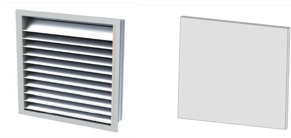
Slika 25. Pojednostavljena geometrija žaluzine
