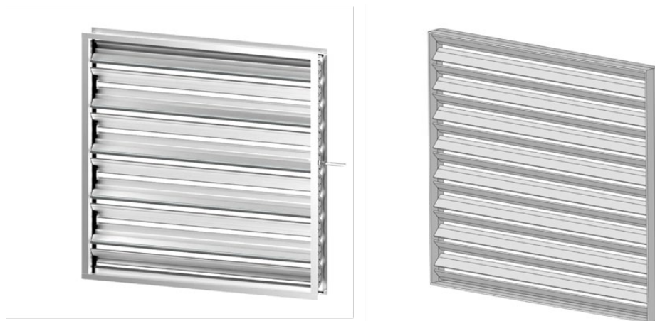
Slika 21. Pojednostavljenje geometrije zaklopke
