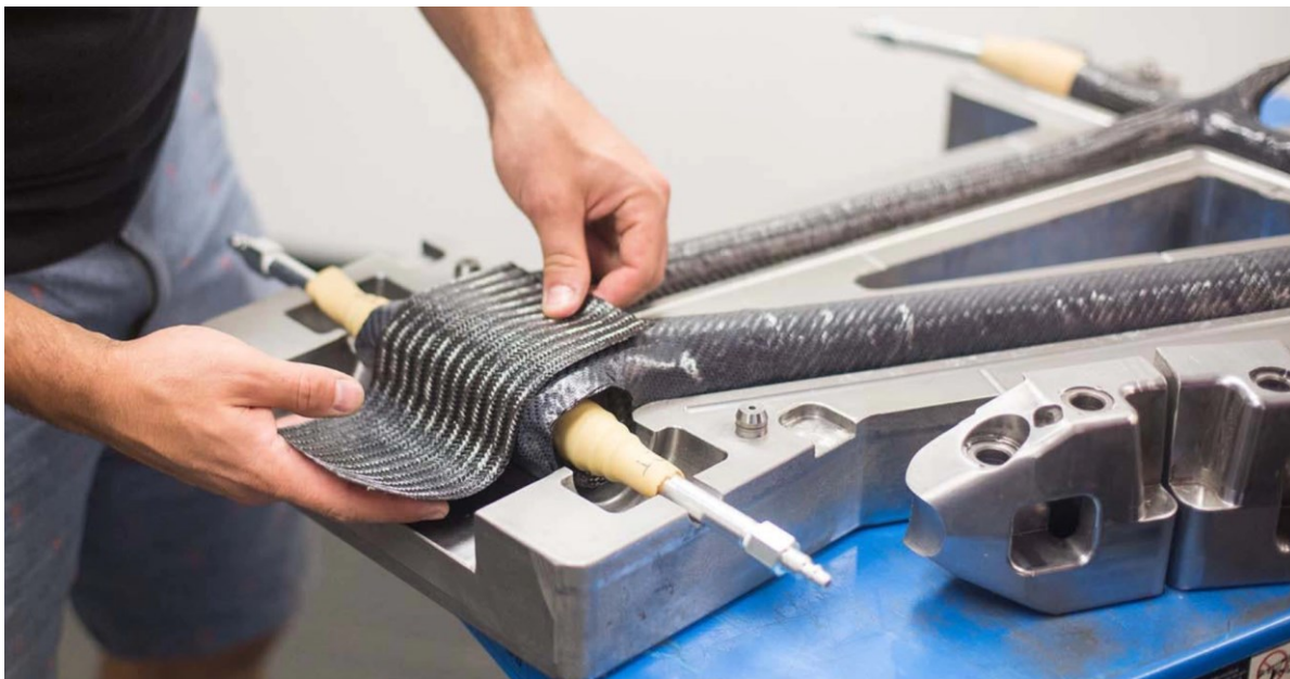
Slika 2 Polaganje predimpregnirane tkanine od ugljičnih vlakana u kalup [5]
