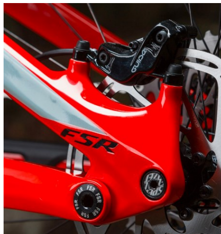
Slika 53 Prihvat kočionih kliješta kod modela Specialized Enduro [28]
