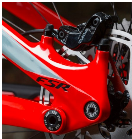
Slika 53 Prihvat kočionih kliješta kod modela Specialized Enduro [28]
