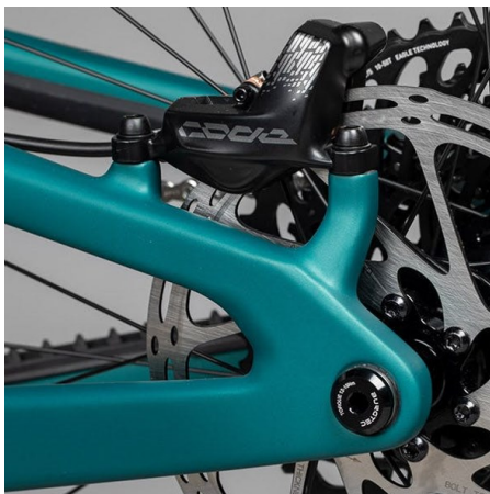
Slika 52 Prihvat kočionih kliješta kod modela Santa Cruz Megatower [5]
