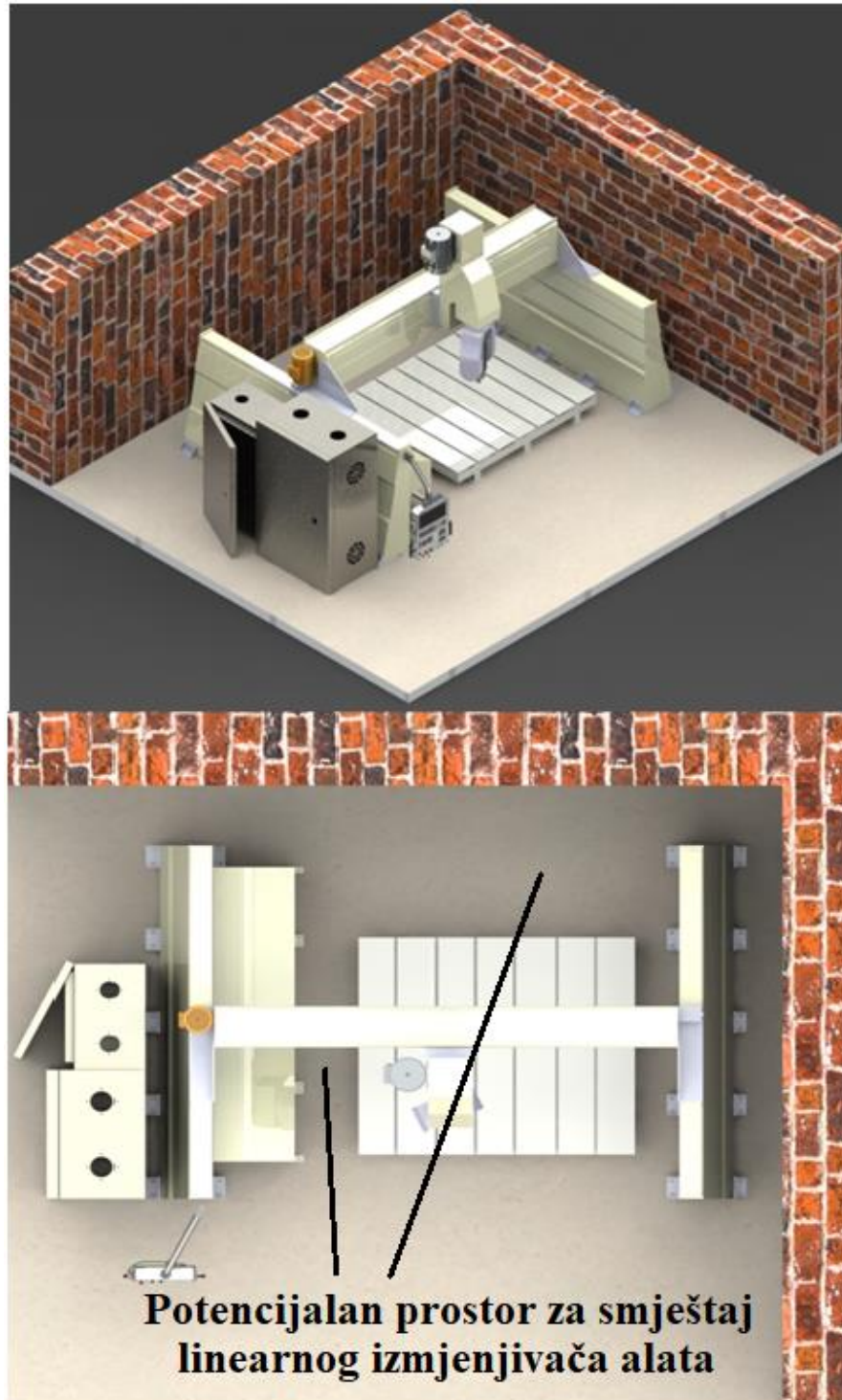
Slika 61. Konceptualan 3D model Mill5 GOC -a izrađen u SOLIDWORKS -u
