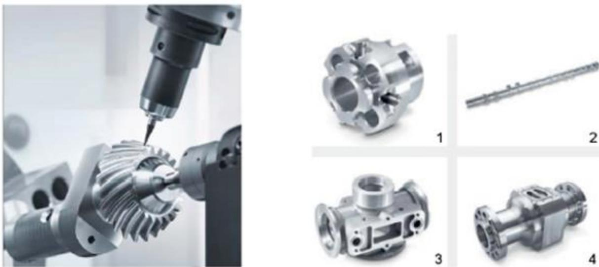
Slika 23. Lijevo: istodobno glodanje konusnog zupčanika; Desno: različiti izratići za automobilsku industriju proizvedeni na istom obradnom sustavu: 1 – kalupni element, 2 – koljenasto vratilo, 3 -kućište ventila, 4 – dio priključka za koljenasto vratilo [19]
