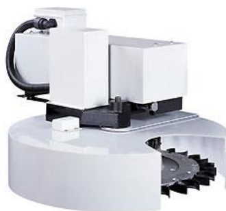
Slika 49. Karuselni izmjenjivač alata [31]
