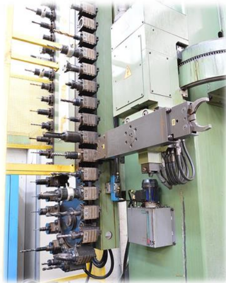
Slika 34. Lančano spremište alata: gore [8] dolje [24]
