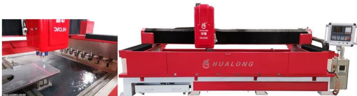
Slika 57. 3-osni portalni GOC tvrtke Hualong Machinery CO.
