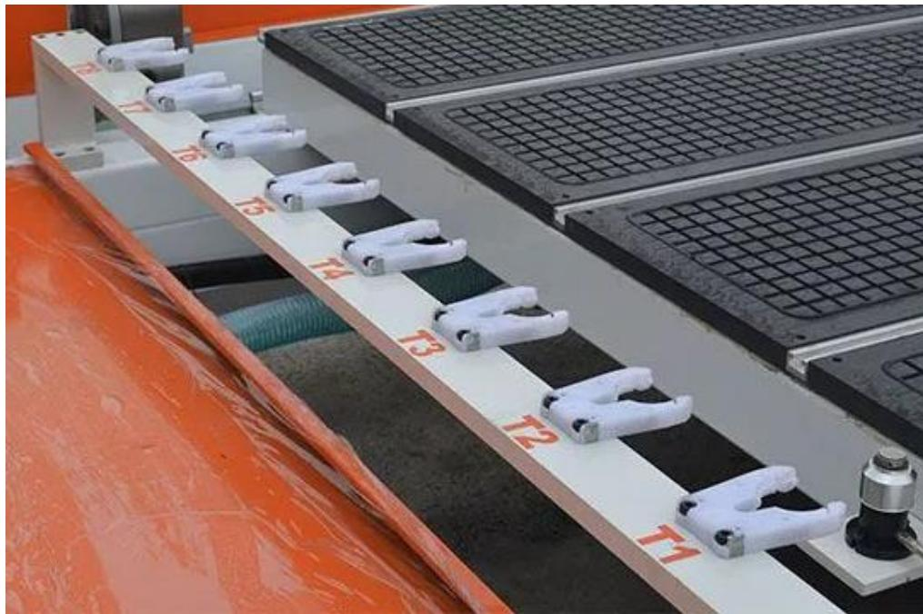
**Slika 51. Prihvavnice držača alata na staku pored postolja obradnog centra [33]**
