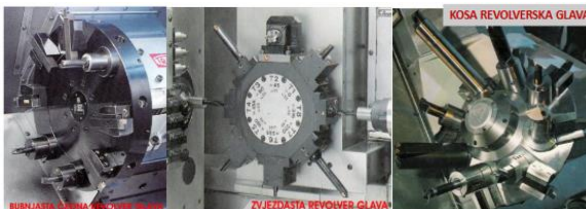
Slika 32. Tipovi revolveraskih glava [8]
