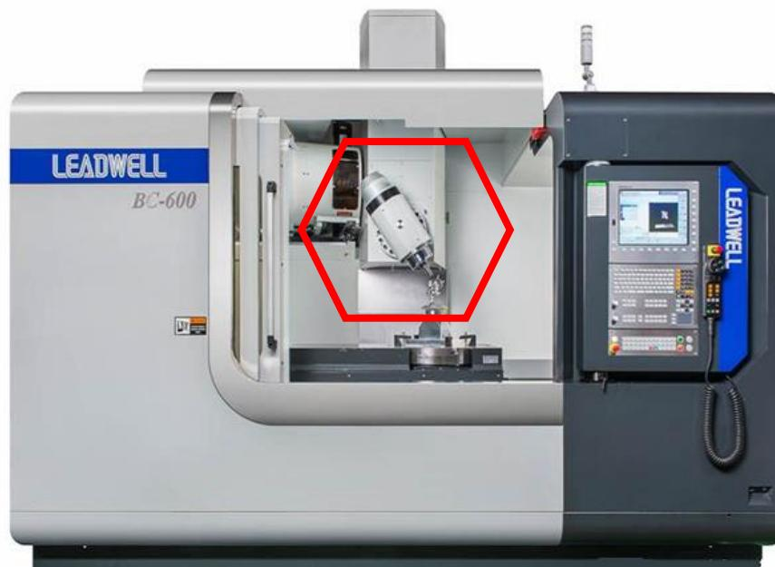
Slika 17. Vertikalni glodači centar sa zakretnim glavnim vretenom - LEADWELL BC - 600
