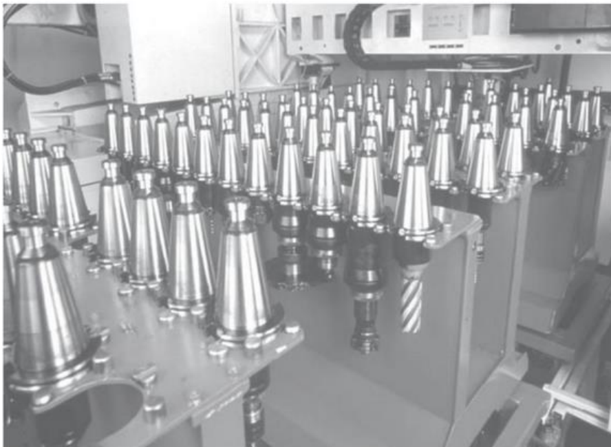
Slika 35. Kazetno spremište alata [25]
