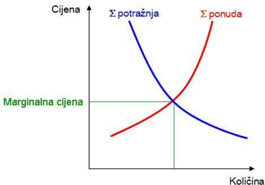
*Slika 3. Određivanje marginalne cijene električne energije [12]*
