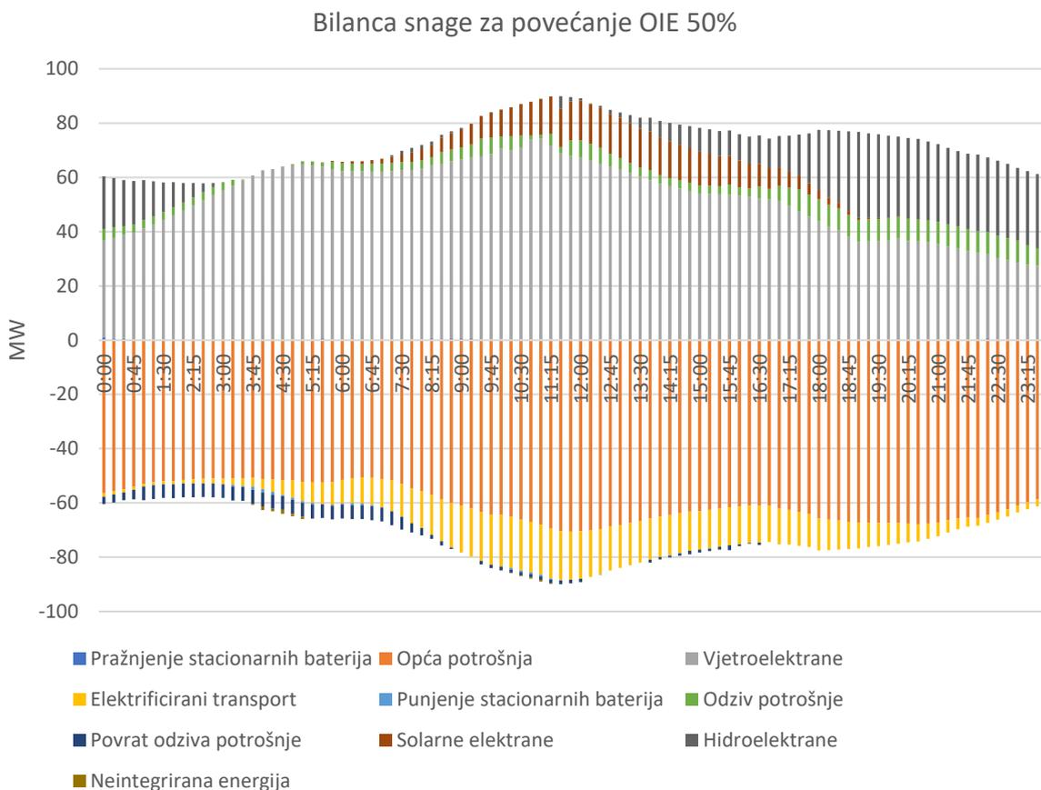
**Slika 34. Bilanca snage za S4 i IPD uz povećanje kapaciteta vjetroelektrana i solarnih elektrana za 50%**
