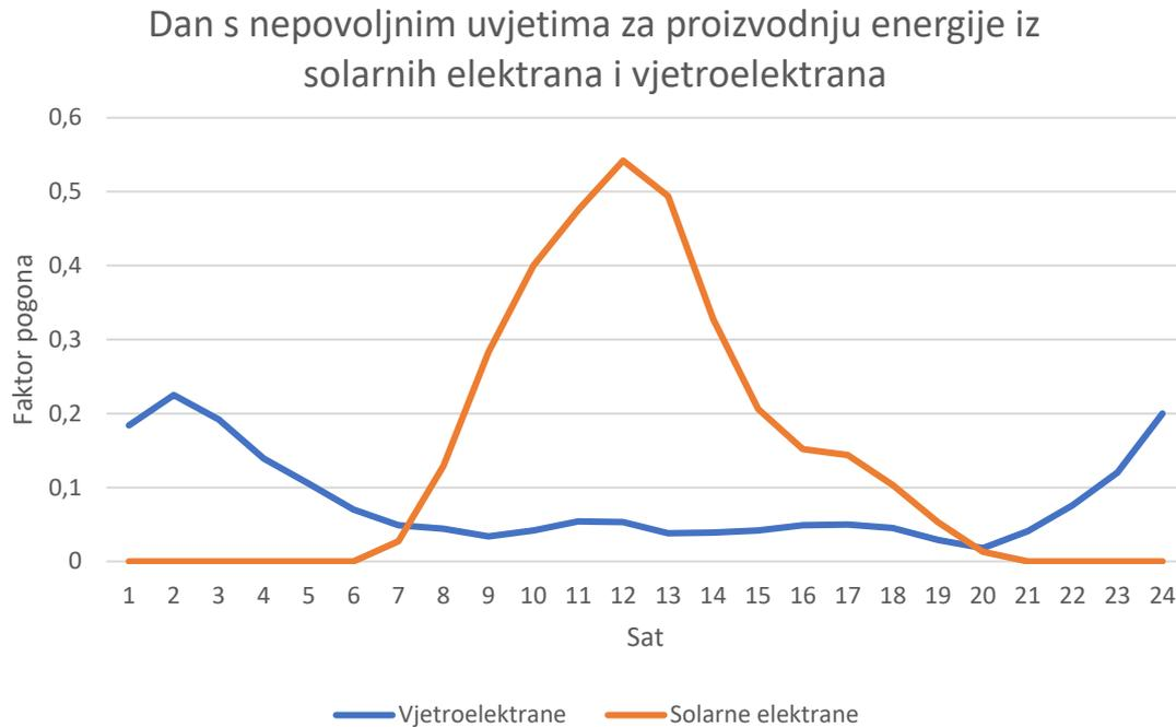
*Slika 17. Faktor pogona vjetroelektrana i solarnih elektrana za dan s nepovoljnim uvjetima za proizvodnju energije*
