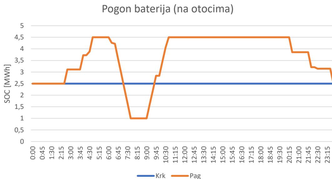
**Slika 27. Pogon stacionarnih baterijskih spremnika raspoređenih na otocima**
