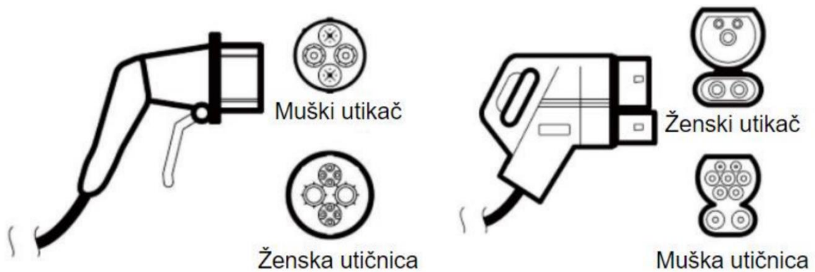
Slika 7. CCS (desno) i CHAdeMO (lijevo) priključak za punjenje istosmjernom strujom [26]
